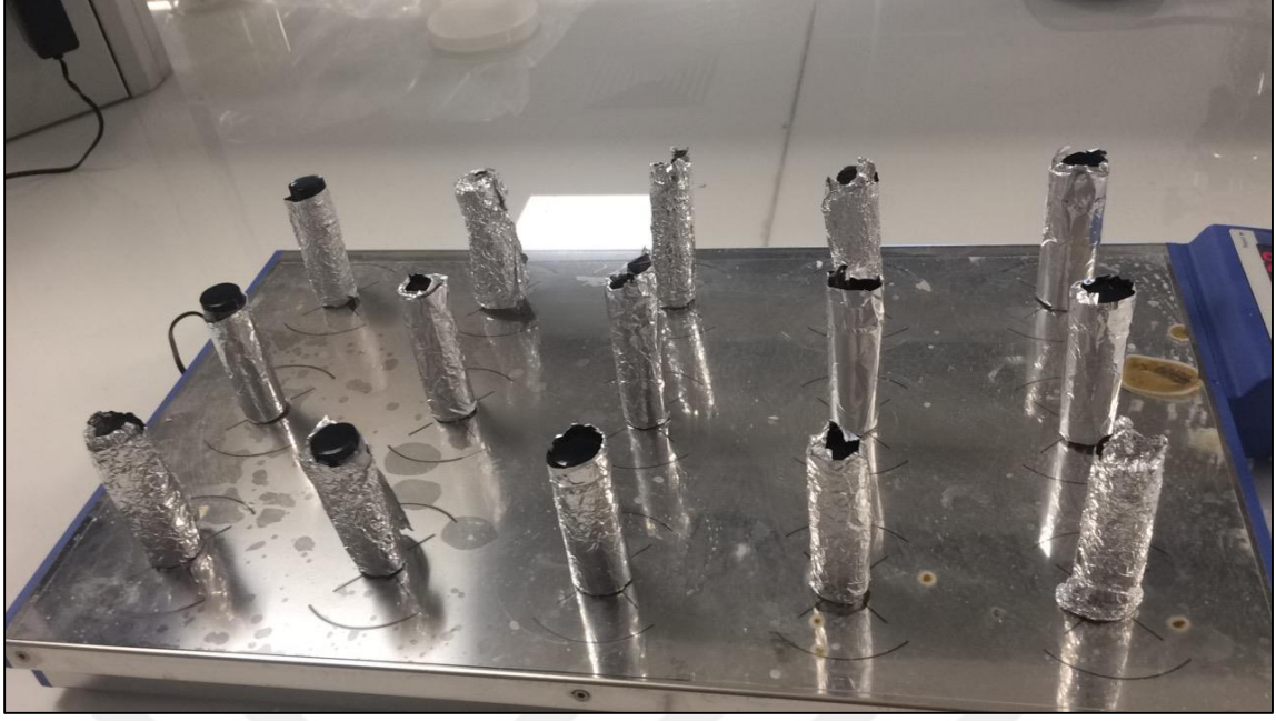
Şekil 3.4. Manyetik karıştırıcıdaki alüminyum folyo ile sarılmış vialler
