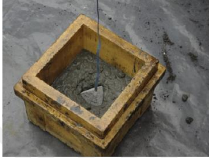
Şekil 3.2.5.3. Beton numunesine yerleştirilmiş sensörlerden bir görüntü (Barroca ve ark., 2013)
