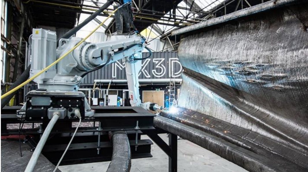
Şekil 1.3. 3 boyutlu yazıcı ve robotlarla üretilmiş çelik köprü (Block, 2018)
