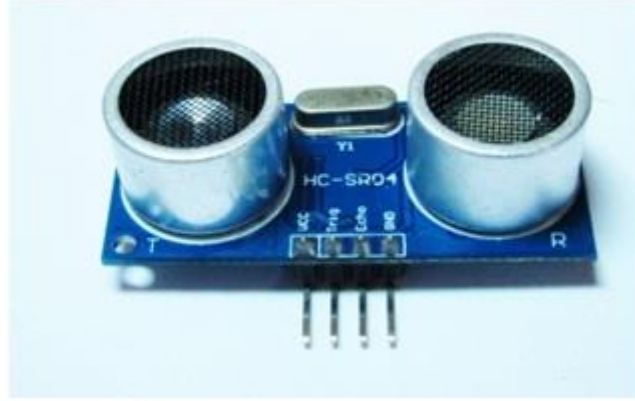
Şekil 3.8.1. Ultrasonik sensör (Anonim, URL-6)
