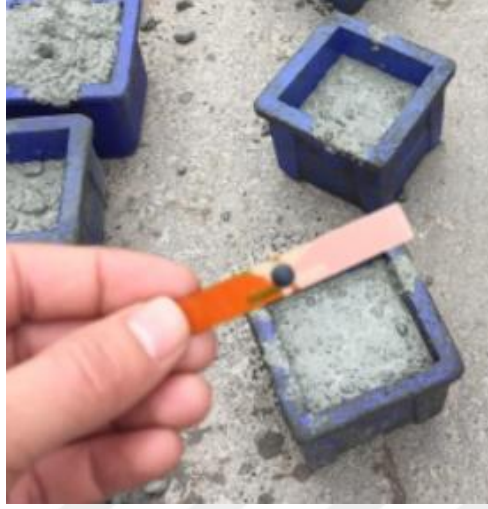
Şekil 3.5.1.3. Numuneye yerleştirilen RFID etiketi (Anonim, URL-5)
