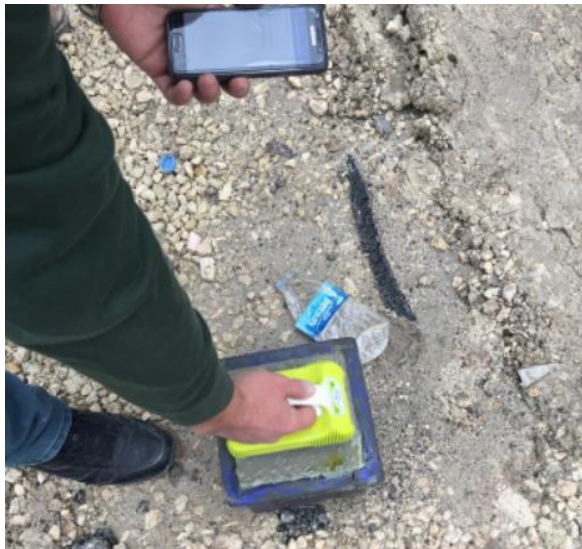
Şekil 3.5.1.4. El terminali ile numunelerin tanımlanması (Anonim, URL-5)
