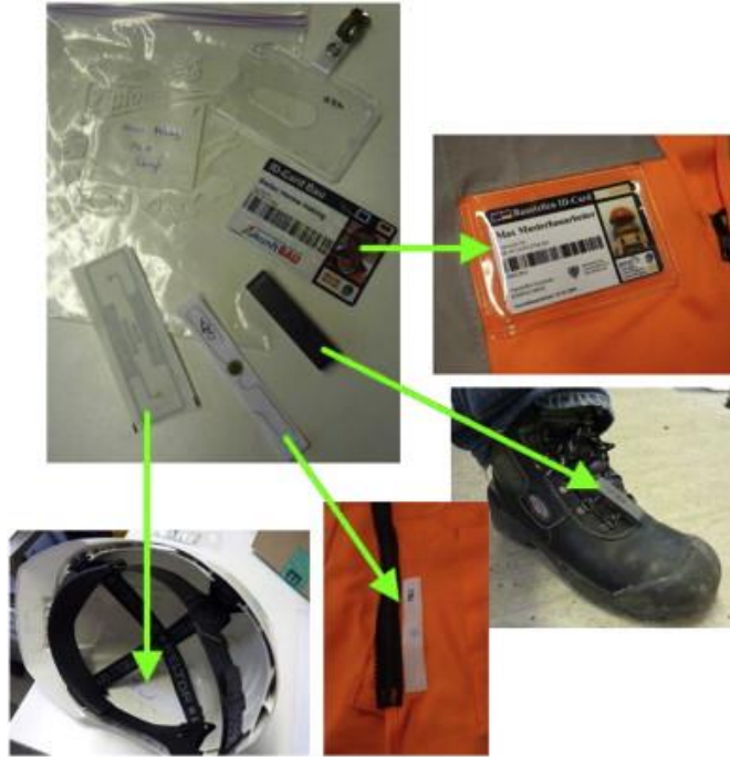
Şekil 3.5.1.1. Kişisel Koruyucu Ekipmanlara Yerleştirilen RFID Etiketler (Kelm ve ark., 2013)
