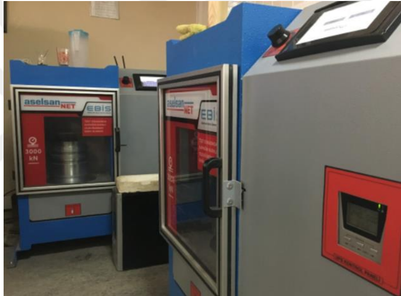
Şekil 3.5.1.5. ASELSAN tarafından üretilen beton basınç dayanım testi cihazı (Anonim, URL-5)
