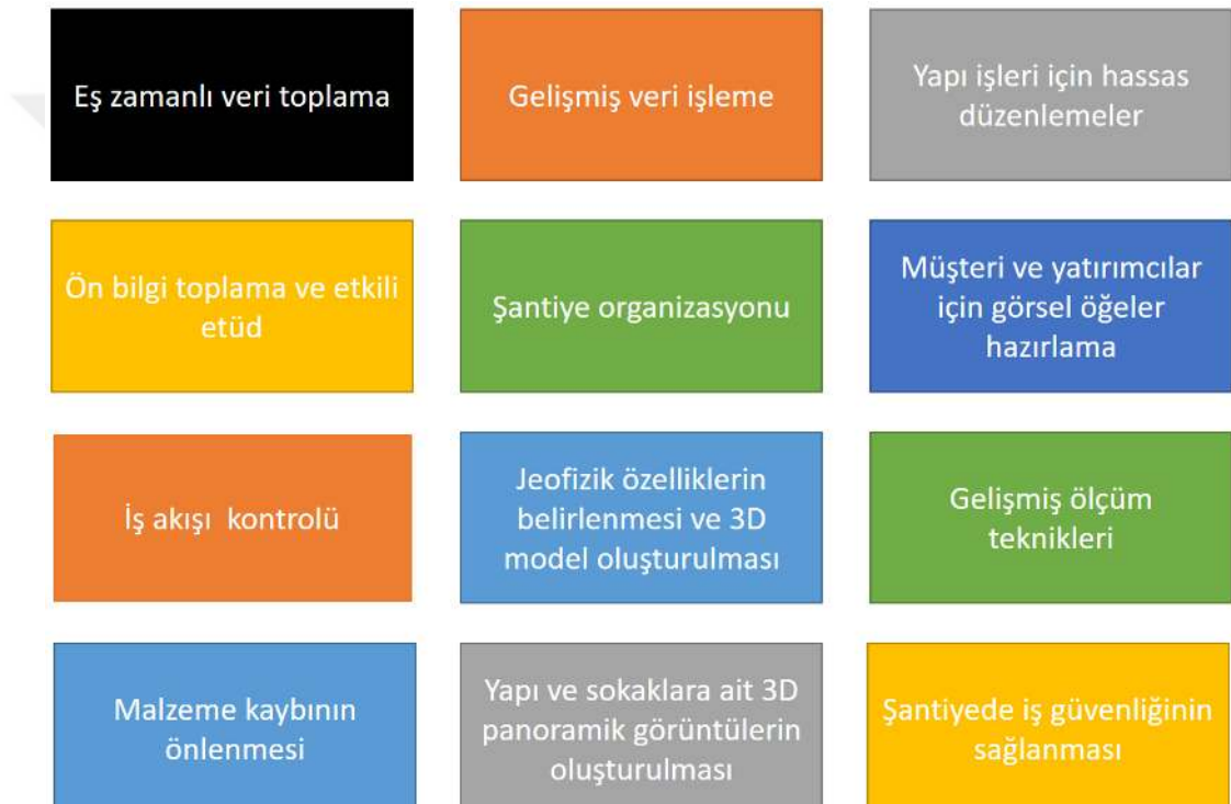
Şekil 4.6 Dron ve İHA kullanan akıllı inşaat izleme sisteminin temel unsurları (Anwar vd., 2018)
