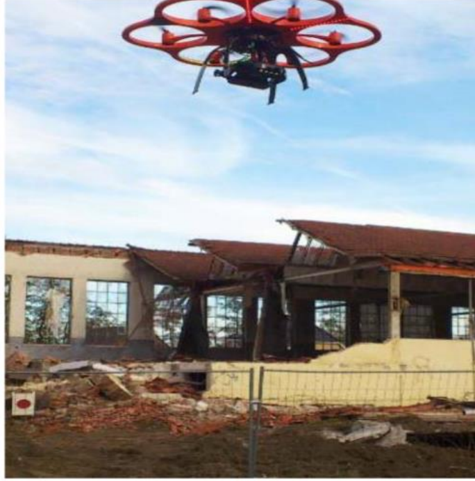
Şekil 3.2 Yapısal hasar değerlendirmesi için dron tabanlı kamera kullanımı (Kerle vd., 2014)
