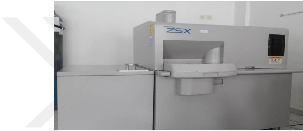
Şekil 3.1. ZSX 1000e WDXRF cihazı
