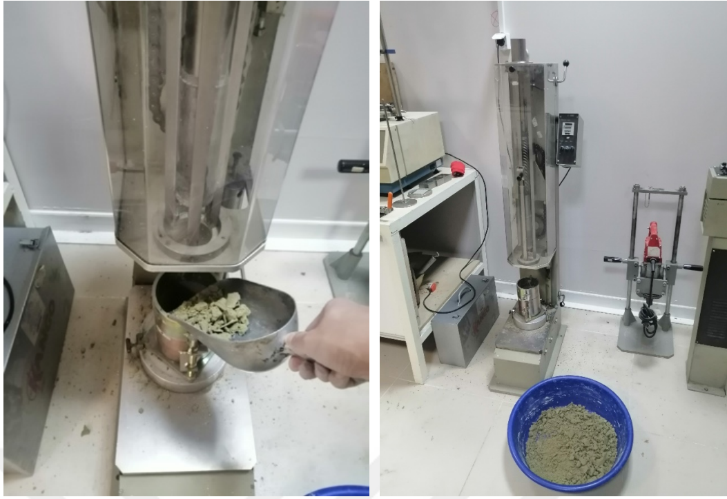
Şekil 3.11. Standart proktor deney aleti
