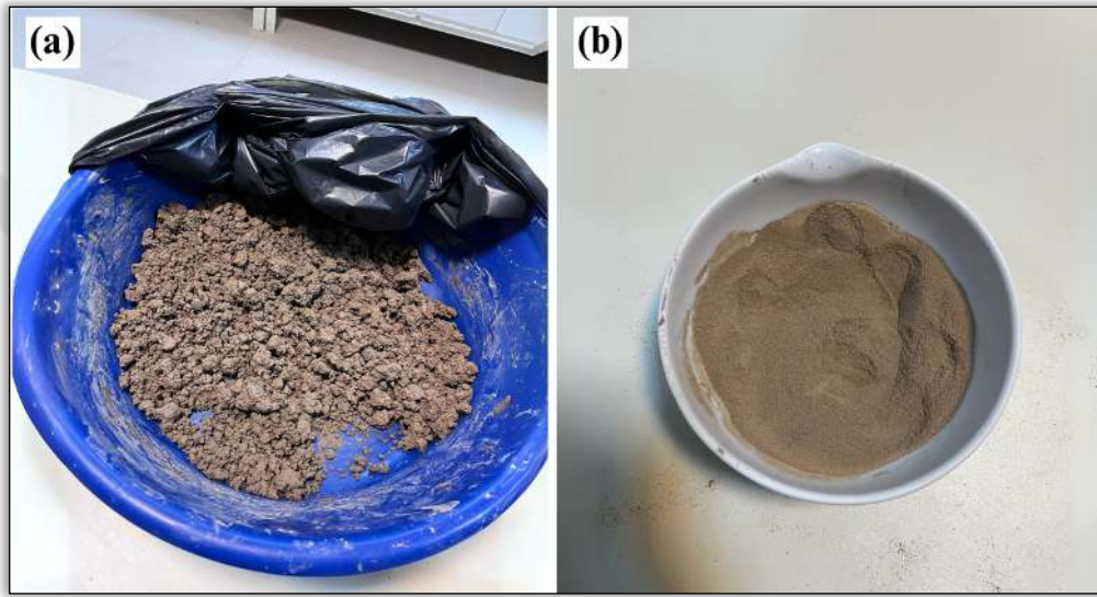
Şekil 3.1. Deneyde kullanılan kil zemini: (a) Doğal halde elde edilen kil numunesi, (b) Etüvde kurutulmuş ve 40 No'lu (0.425mm) elekten geçirilerek elde edilen kil malzemesi
