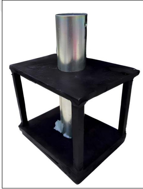
Şekil 3.16. Laboratuvar ortamında hazırlanan deney numunesi hazırlama aleti
