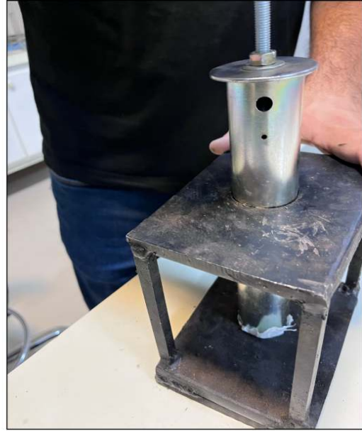
Şekil 3.16. Laboratuvar ortamında hazırlanan deney numunesi hazırlama aleti
