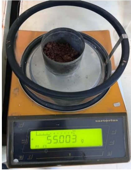
Şekil 3.15. Sıkıştırma öncesinde, 3 farklı kapta eşit ağırlıkta hazırlanan numuneler
