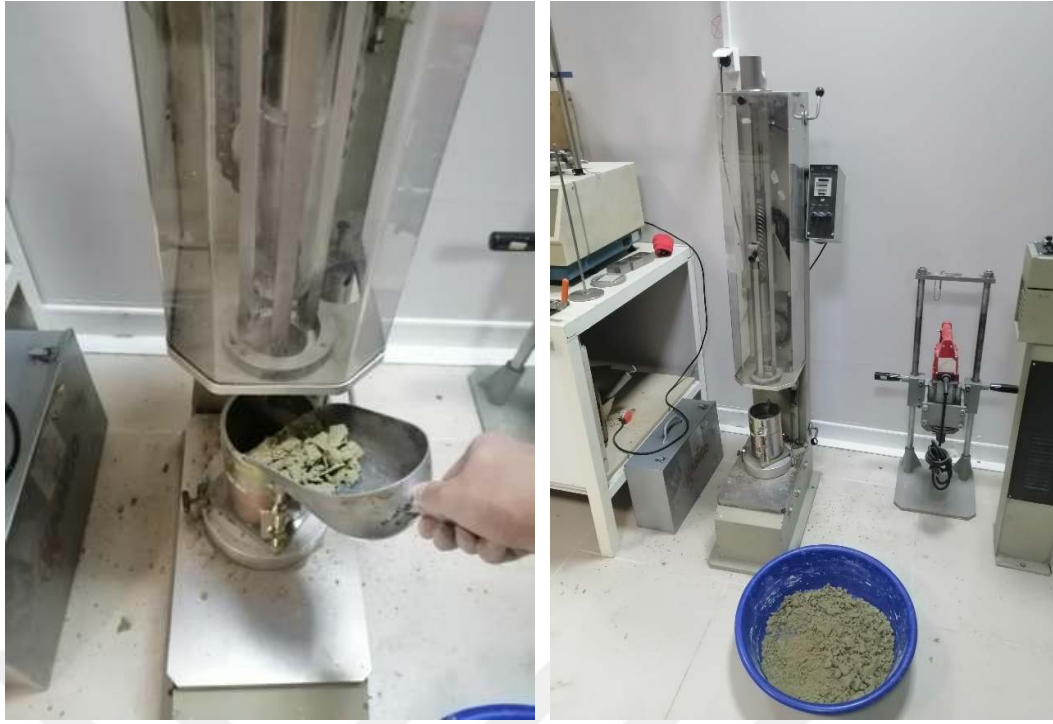
Şekil 3.11. Standart proktor deney aleti
