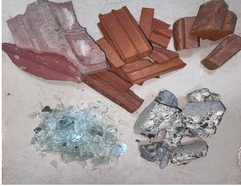
Şekil 3.3. Çalışmada kullanılan ayrıştırılmış inşaat atıkları: Tuğla, cam ve beton parçaları
