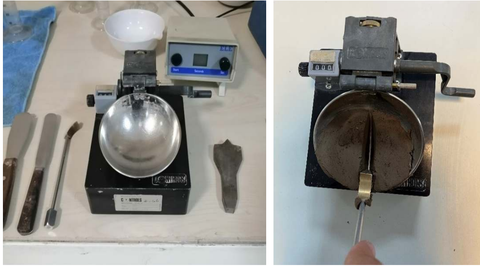
Şekil 3.8. Deneyde kullanılan standart likit limit aleti
