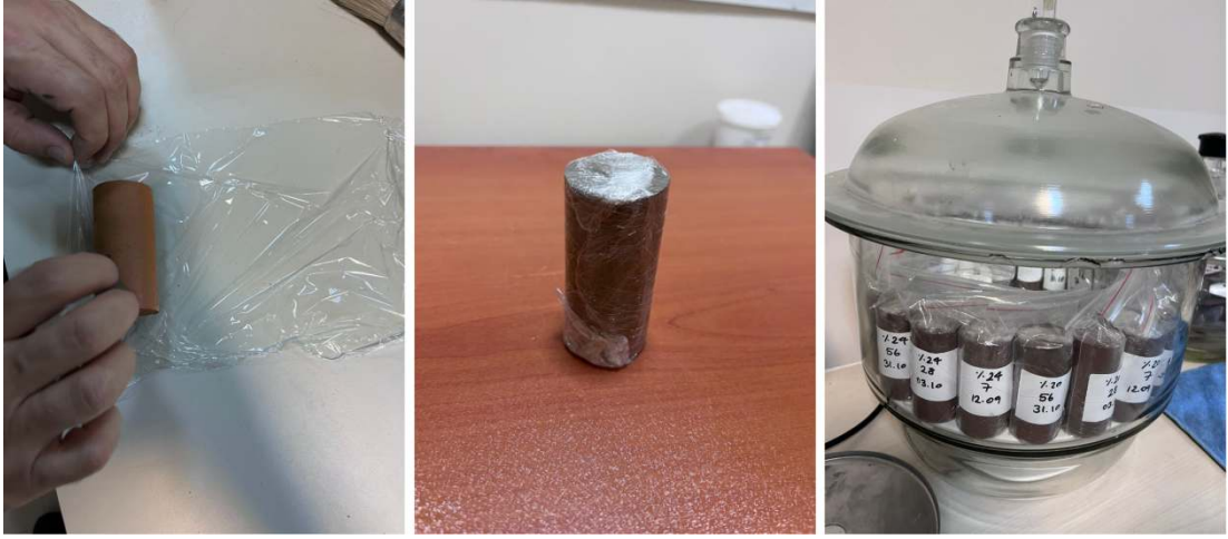
Şekil 3.18. Numunelerin streç film ile sarılması ve desikatöre konulması
