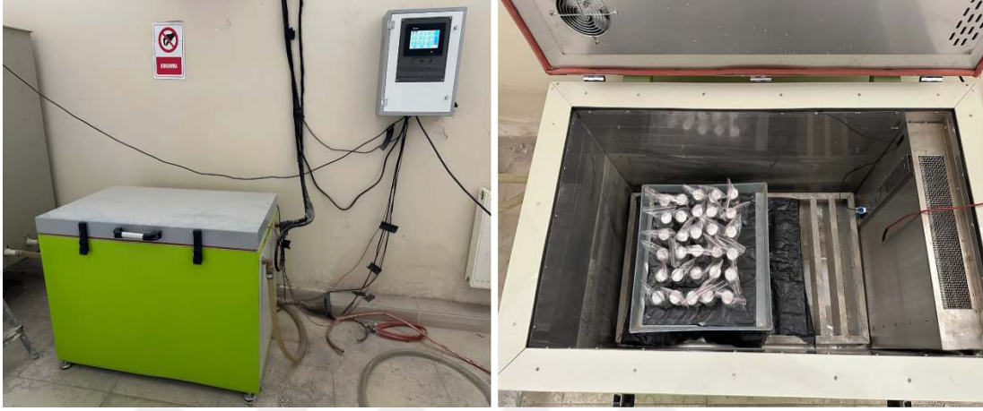
Şekil 3.20. Donma-çözölme cihazı ve donma-çözölme deney numuneleri
