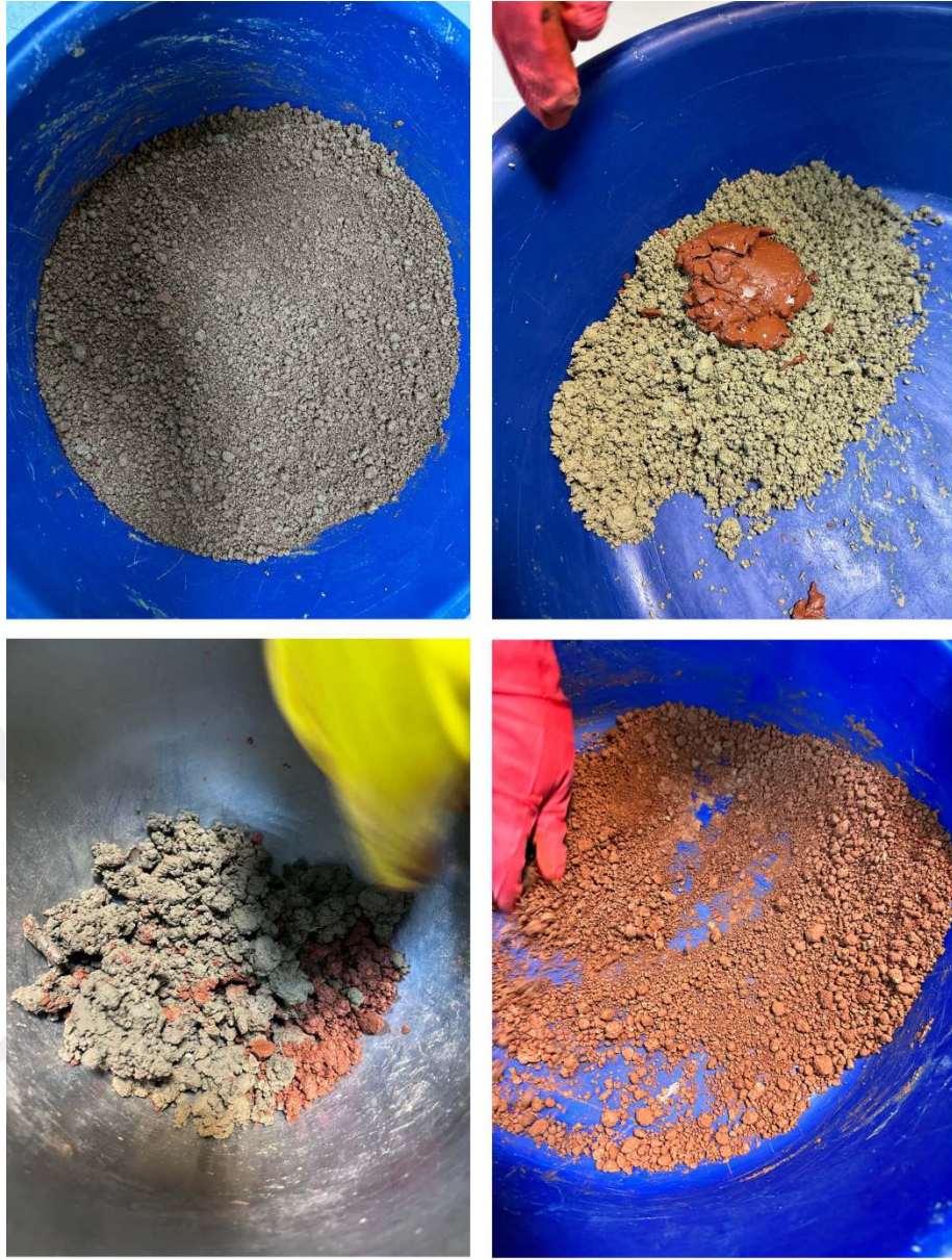
Şekil 3.14. Optimum su muhtevasında hazırlanan zemin ile geopolimer bağlayıcının karıştırılması
