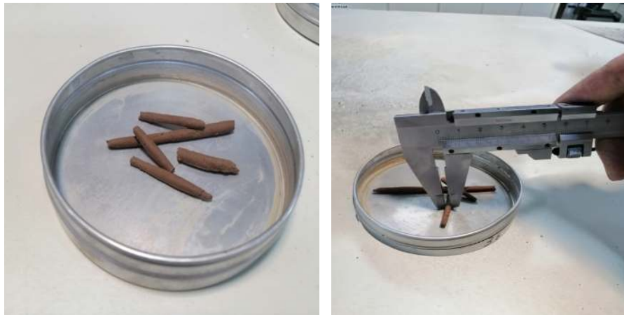
Şekil 3.9. Plastik limit deneyi numuneleri
