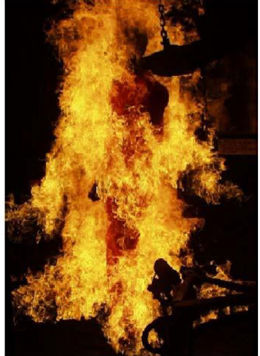
Şekil 3.3 Giysilerin termal koruyucu performansını ölçmek için yapılan manken testi (Song, 2002)
