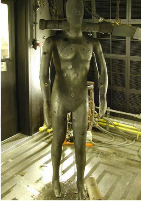
Şekil 3.3 Giysilerin termal koruyucu performansını ölçmek için yapılan manken testi (Song, 2002)
