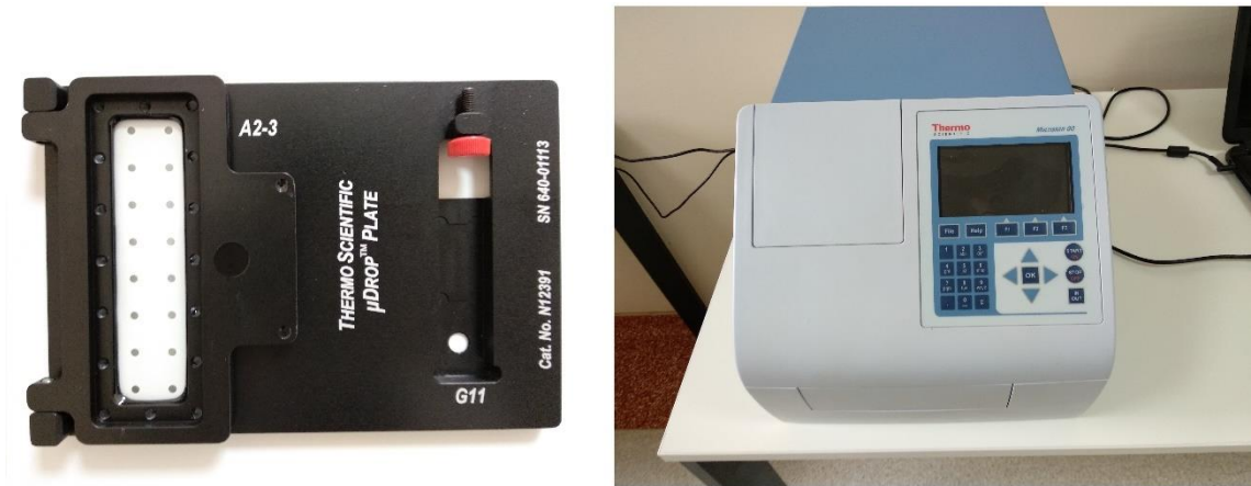
Resim 3. 5: Mikro-hacim spektrofotometre cihazında ölçüm için kullanılan plate ve mikro-hacim spektrofotometre cihazı
