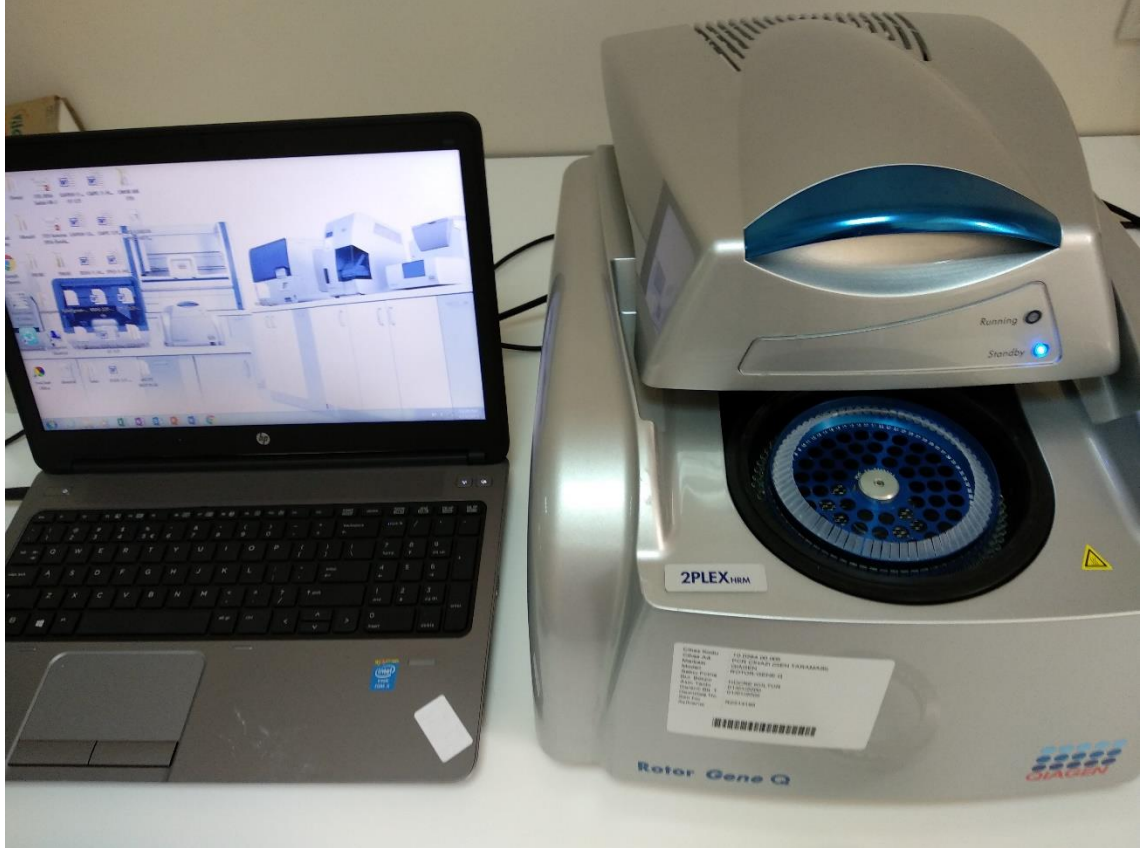
Resim 3. 6: Kantitatif PCR cihazı ve ölçümlerin yapıldığı bilgisayar sistemi
