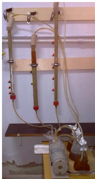
Şekil 6.2 : Kesikli sistemde yükleme deneyleri için deney düzeneği.
