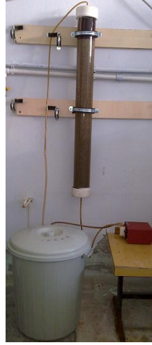
Şekil 6.3 : Büyük boyutlu kolonda yükleme deneyleri için deney düzeneği.
