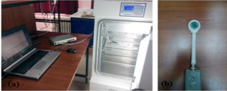
Şekil 3.11. a) Deney düzeneği b) QCM sensör tutucu.
