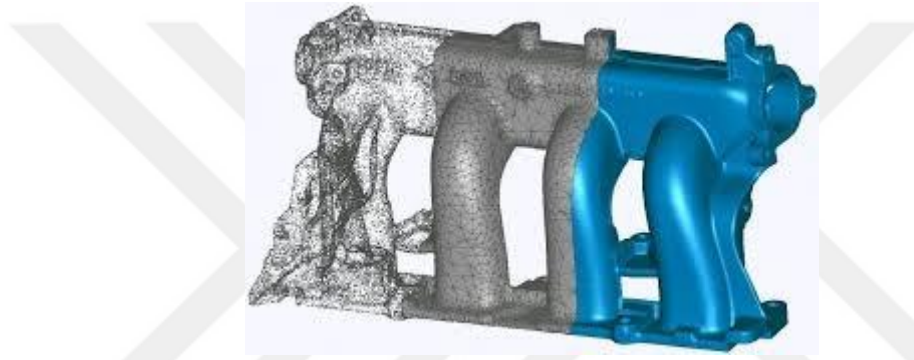
Resim 2.17 Tarayıcı ile üründen alınan nokta bulutu ve 3B boyutlu çizim (İnt. Kyn. 9).
