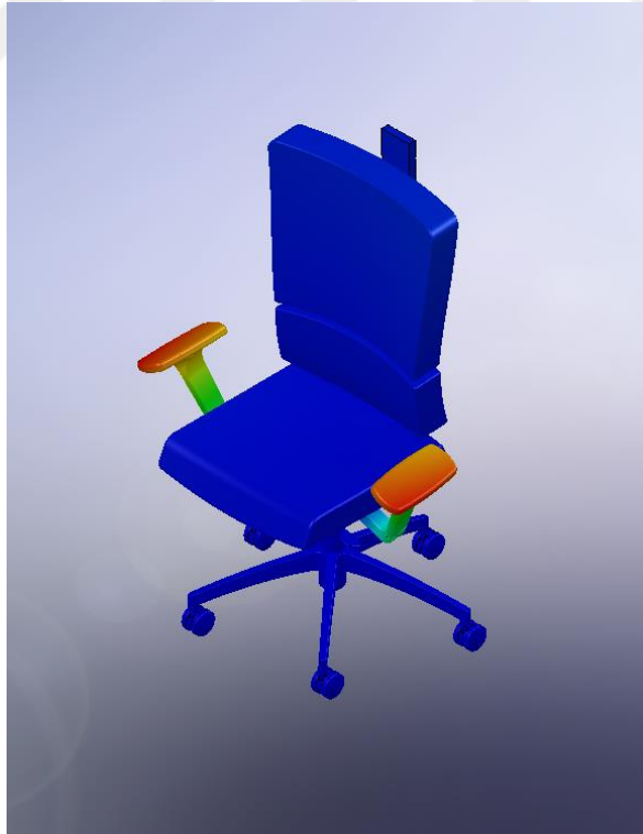
Şekil 2.28 Ofis koltuğu 2. titreşim biçimi (3,0716 Hz)
