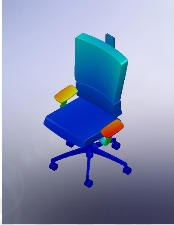
Şekil 2.27 Ofis koltuğu 1. titreşim biçimi (2,9041 Hz)
