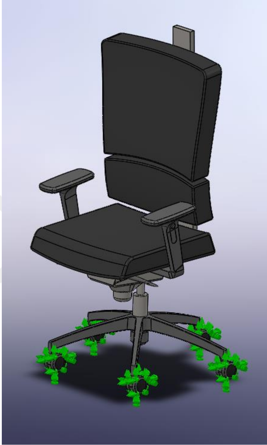
Şekil 2.25 Doğal frekans analizi için koltuğa sınır koşulu atanması
