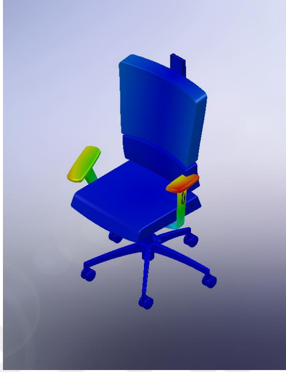
Şekil 2.31 Ofis koltuğu 5. titreşim biçimi (3,9616 Hz)
