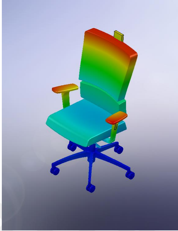
Şekil 2.29 Ofis koltuğu 3. titreşim biçimi (3,1181 Hz)
