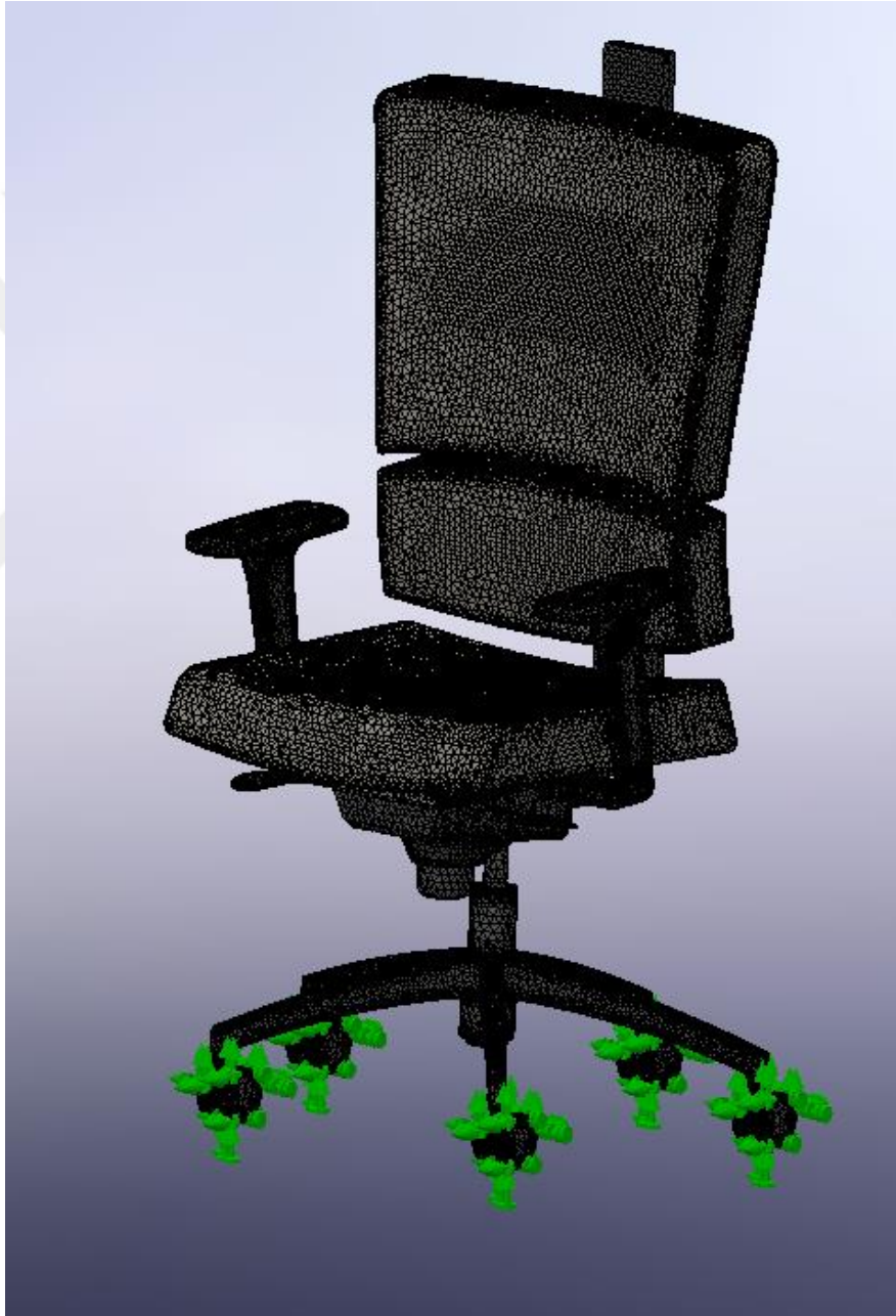
Şekil 2.26 Analiz işlemi için mesh atanması
