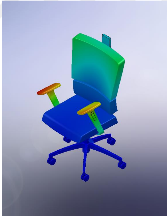
Şekil 2.30 Ofis koltuğu 4. titreşim biçimi (3,2613 Hz)
