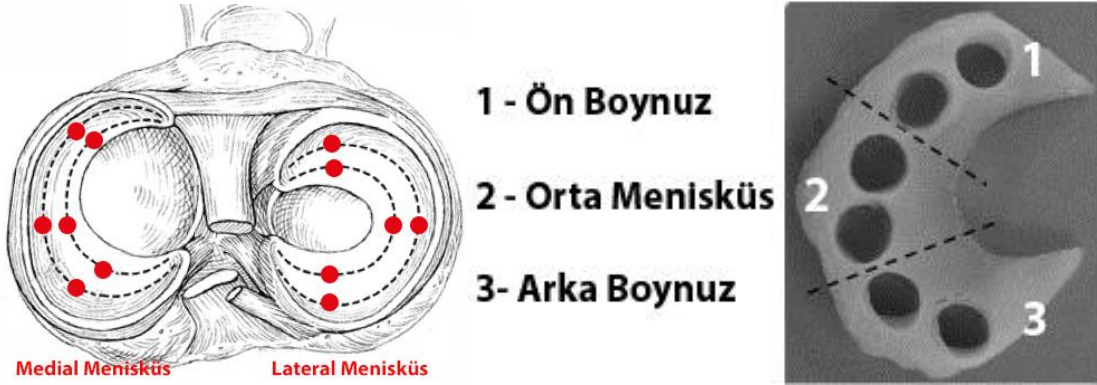
Şekil 10 - Menisküste silindirik numune hazırlanması
