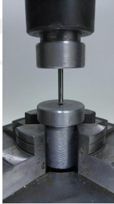
Şekil 13 - Menisküs kıkırdak yüzeyine uygulanan basma testlerinin görünümü
