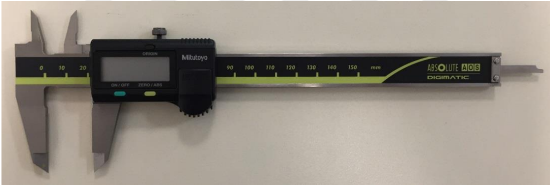
Şekil 3-5: Dijital kumpas (hassasiyet;0.01 mm, aralık 150 mm, Mitutoyo 500-181-30, Japonya).
