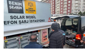
(d) Solar mobile charging station My City Project [5]
