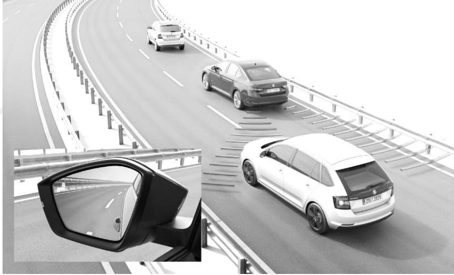
Şekil 3.6. Kör nokta uyarı sistemi [85]
