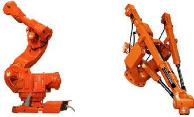
Şekil 2.4. Seri robot (solda) ve paralel robot (sağda) [24].
