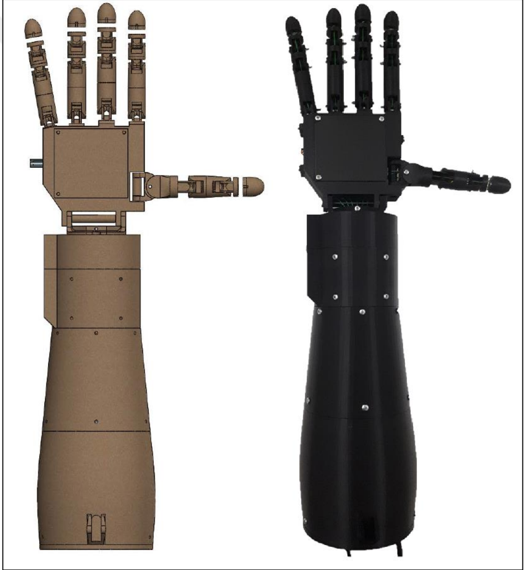
Şekil 6.1 İnsansı robot kol tasarım ve gerçekleştirilmiş hali ön görünüş (Kişisel arşiv, 2018)
