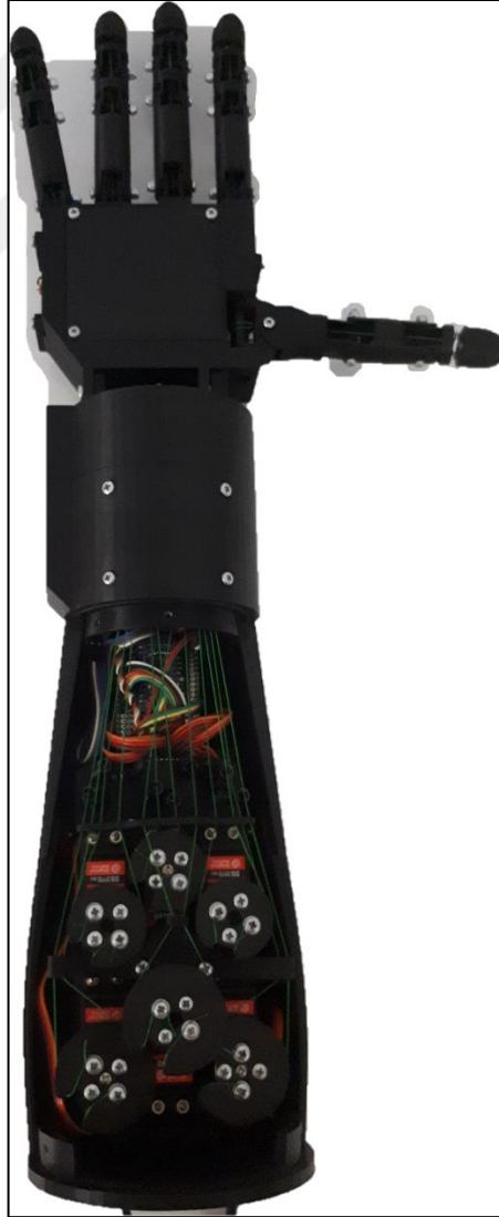
Şekil 6.5 İnsansı robot kol motor yerleşimi ve tendonlar (Kişisel arşiv, 2018)
