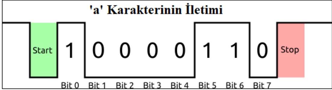
Şekil 4.3 Asenkron seri iletişimde veri transferi (Rajewski, 2018)
