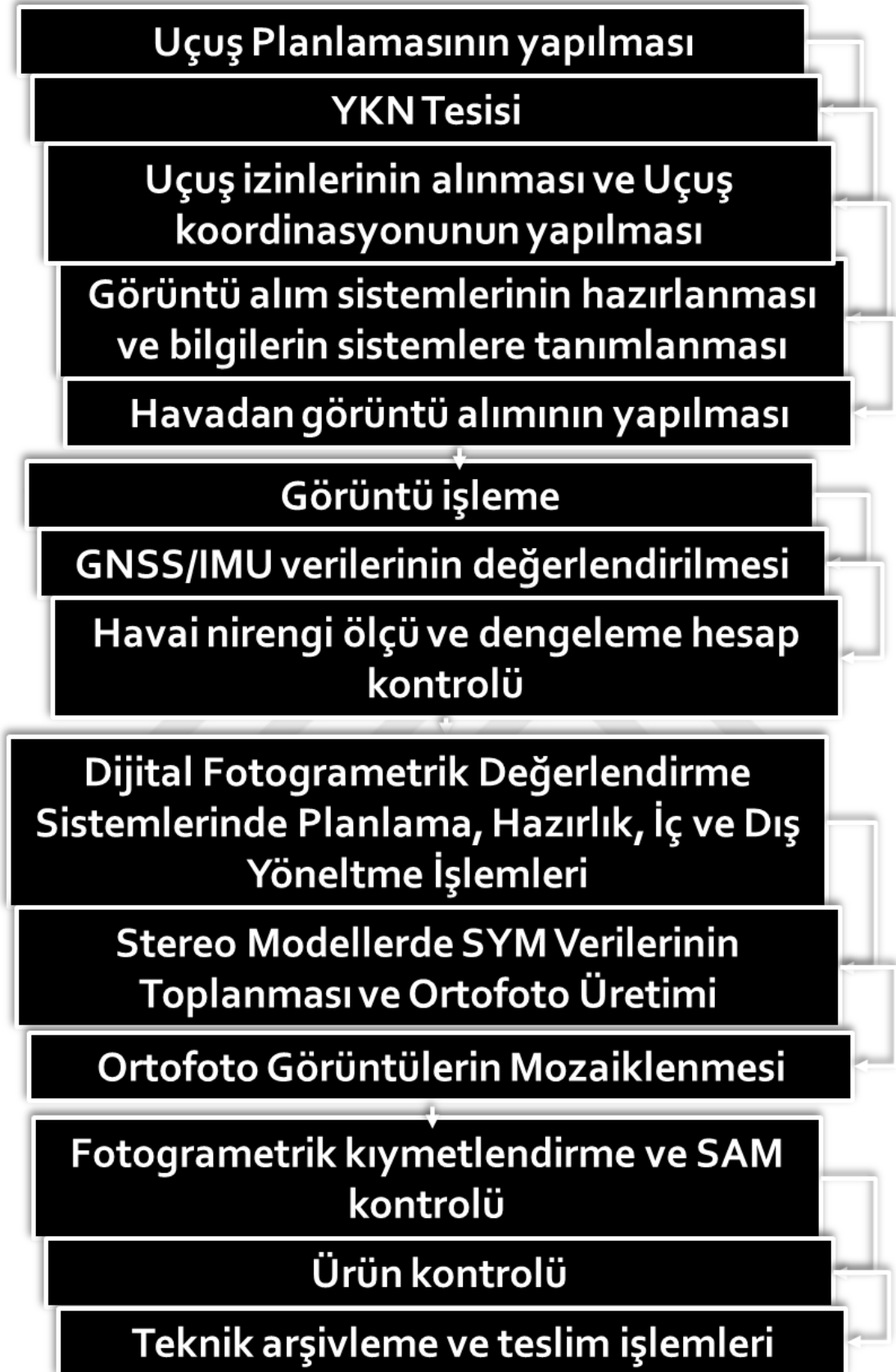
Şekil 3.9. Hava fotogrametrisi iş akış diyagramı
