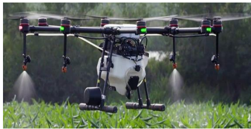
Şekil 2.2. Zirai Amaçla Kullanılan Döner Kanatlı Bir İHA
