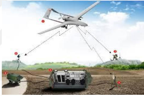
Şekil 2.3. Yer Kontrol İstasyonu-Veri Linki-Hava Aracı
