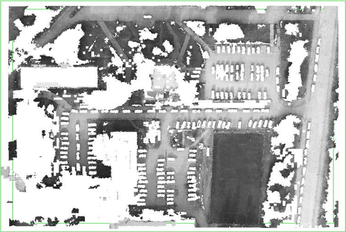
Şekil 3.11. Test Alanı #2'ye ait; a) elde edilen sayısal yüzey modeli (SYM) ve b) elde edilen sayısal arazi modeli (SAM)
