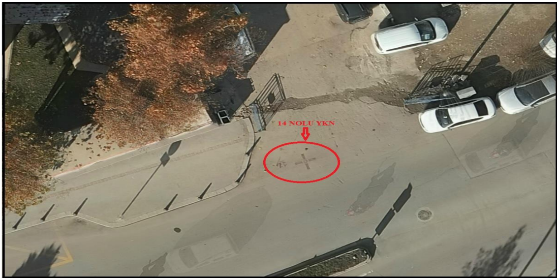
Şekil 5.7. YKN'lerin hava fotoğraflarındaki görünümü.
