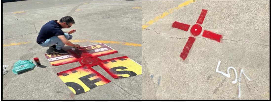
Şekil 5.6. Yer kontrol noktaları tesisi.
