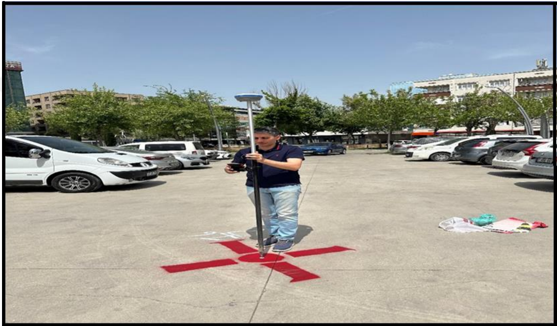
Şekil 5.8. Yer kontrol noktalarının GPS ile ölçülmesi.
