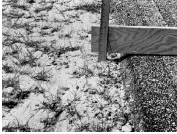
Resim 2.25 Düşük şiddetli kenar/banket düşüklüğü (Gürer 2014)
