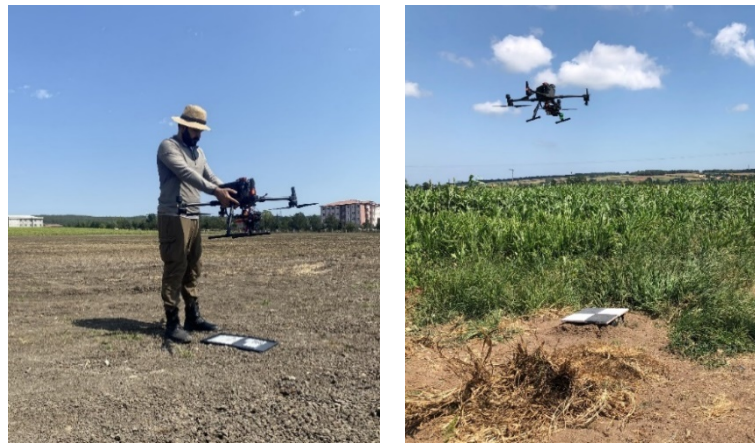
Şekil 3.6. Multi-spektral kameranın kalibrasyonu için plaka okumaları ve yer kontrol noktasına ilişkin görseller.
