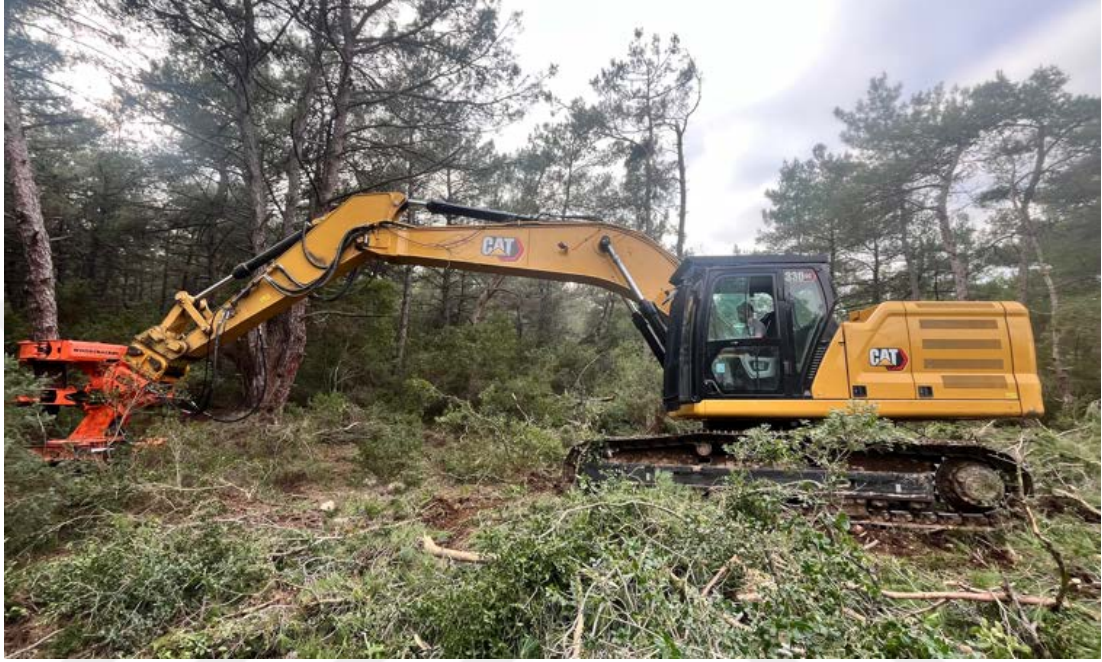
Şekil 3.4 : WoodCraker C550 kesici-istifleyici (S. Akarsu).
