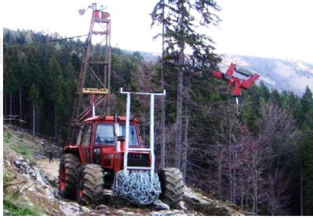
Şekil 1.7 : Koller K300 model kısa mesafeli hava hattı (Büyüksakallı, 2023).
