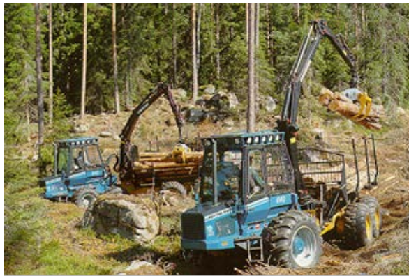
Şekil 1.6 : Taşıyıcı ile bölmeden çıkarma (Akay ve Yenilmez, 2008).
