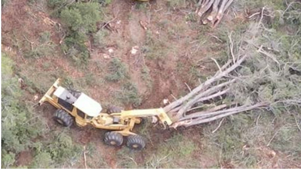
Şekil 3.5 : Tigercat 635D model sürütücü ile sürütmenin İHA ile alınan bir görüntüsü (S. Akarsu).
