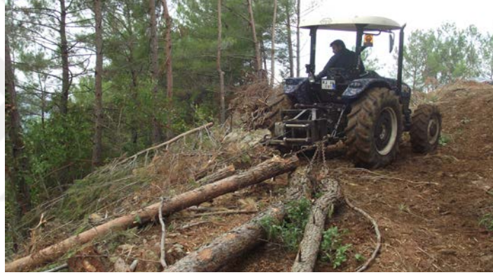
Şekil 1.2 : Tarım traktörü ile bölmeden çıkarma (Büyüksakallı, 2023).
