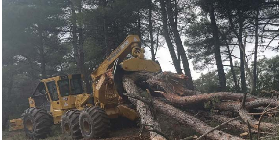
Şekil 1.5 : Sürütücü ile bölmeden çıkarma çalışması (Foto: A.E. Akay).
