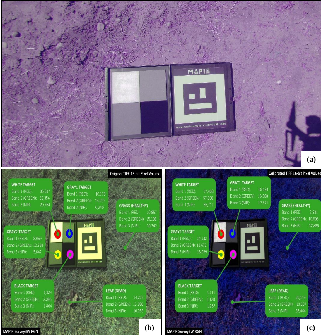
Şekil 3.26. MAPIR kamera yansıma kalibrasyonu; a) Yer hedef paketi (V2); b) Orijinal piksel değerleri; c) Kalibrasyon sonrası piksel değerleri (MAPIR 2022)
