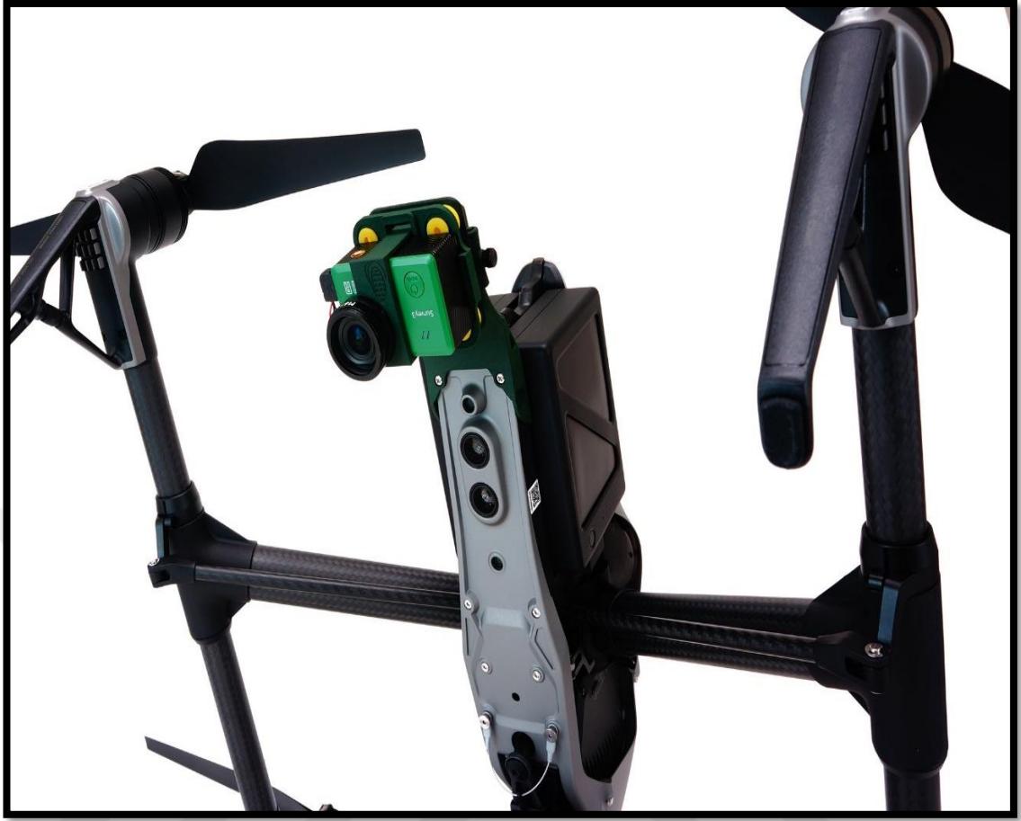
Şekil 3.6. Inspire 2'ye monte edilmiş survey 3 kamera
