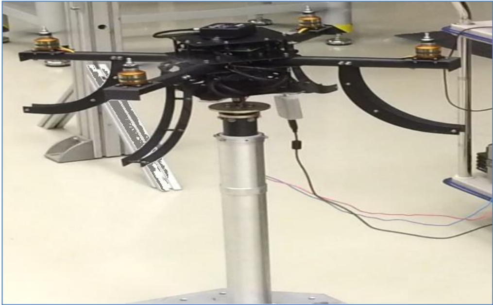
Şekil 5.13 Quadrotor üç eksen test düzeneğinde test edilirken
