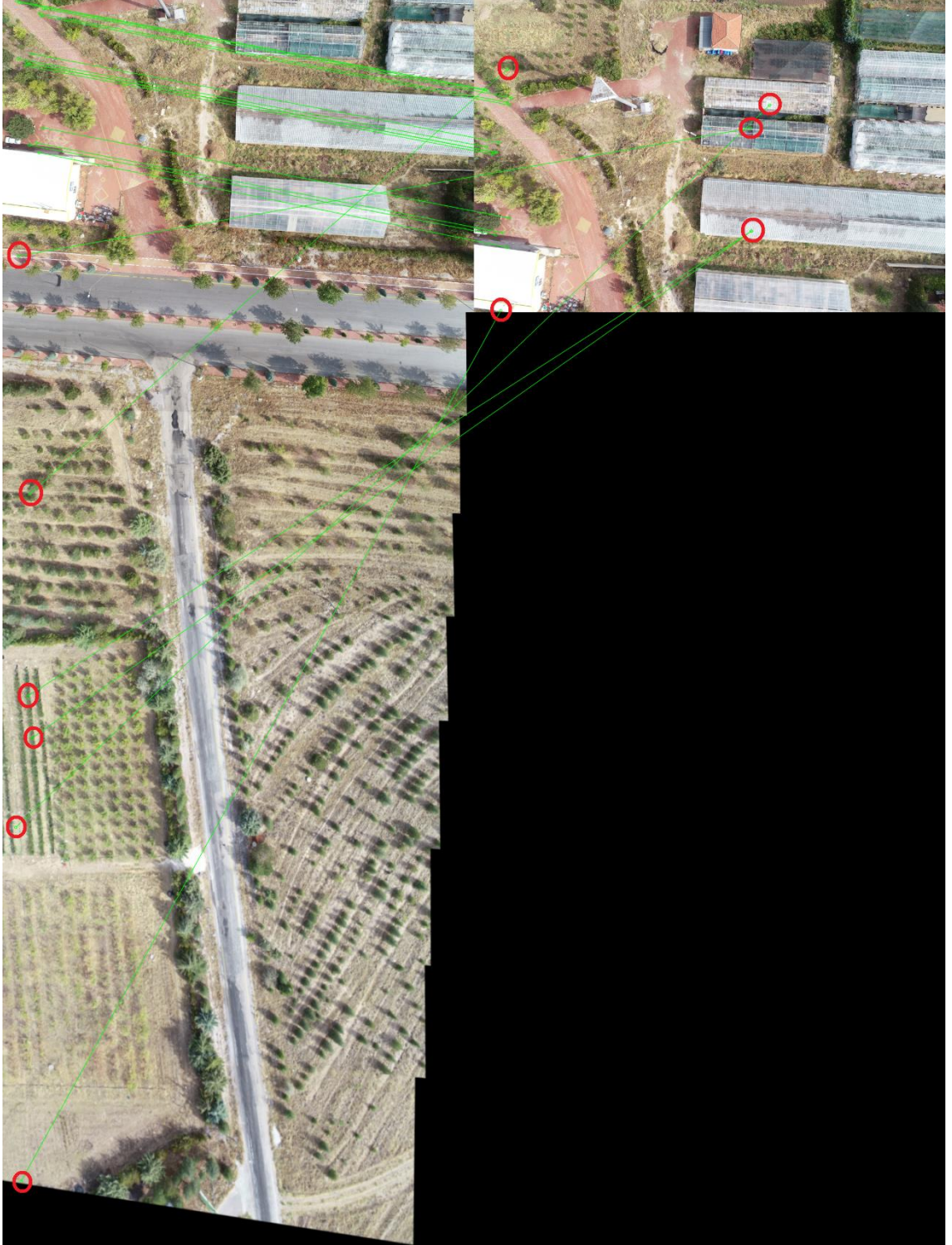
Şekil 4.10. Mozaikleme sürecinde görüntü üzerinde eşleştirilmiş bazı özellik çiftleri
