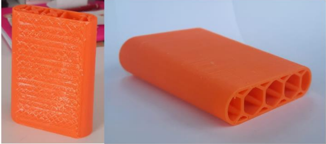
Şekil 6.5 Kötü yüzey kalitesine sahip ve zımparalama işlemi yapılmış numuneler
