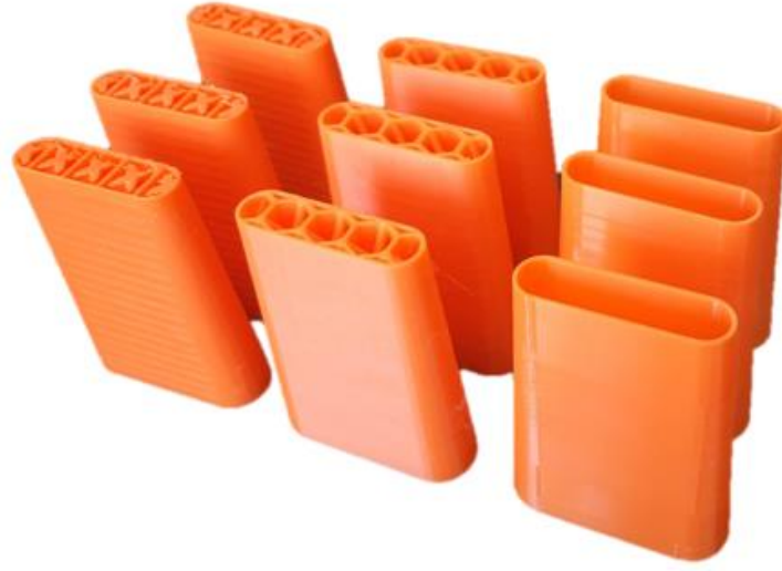
Şekil 6.4 Üretimi gerçekleştirilen basma deney numuneleri
