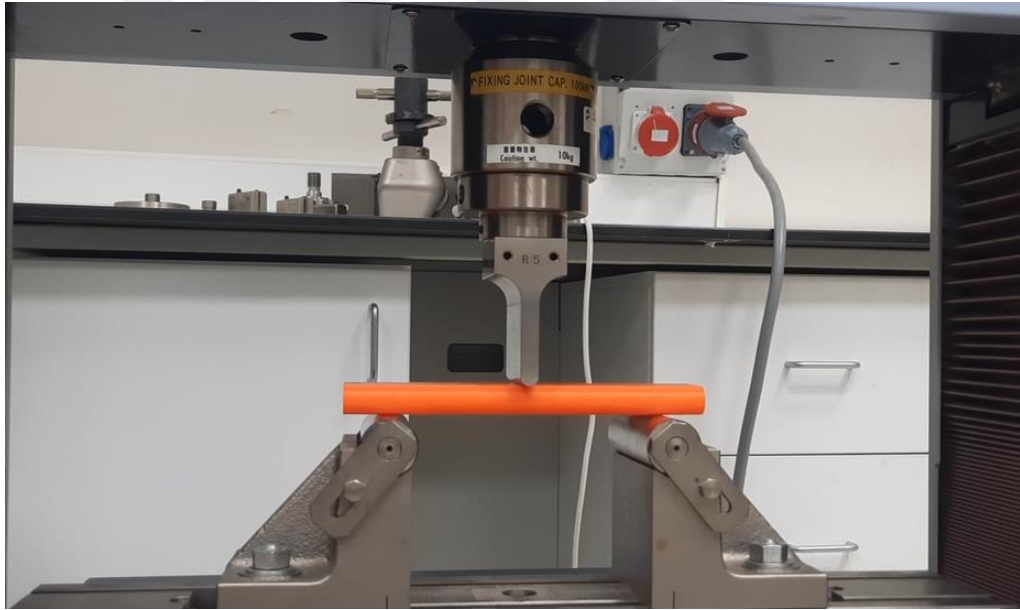
Şekil 6.6 Üç nokta eğme numunelerinin test cihazına yerleştirilmiş görüntüsü
