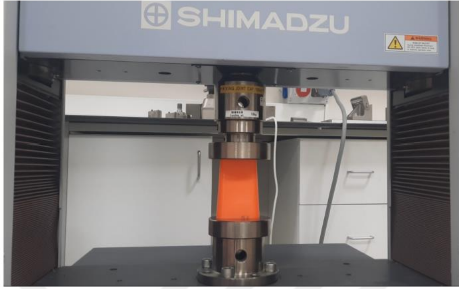
Şekil 6.7 Basma numunelerinin test cihazına yerleştirilmiş görüntüsü
