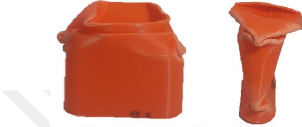
Şekil 6.9 DTB numunelerine ait deformasyon
