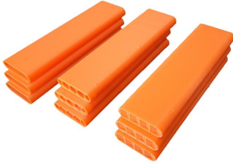
Şekil 6.3 Üretimi gerçekleştirilen üç nokta eğme deney numuneleri
