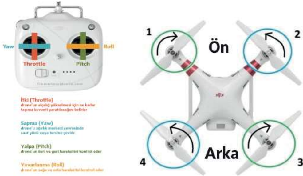
Şekil 2.3 Drone'un Çalışma Sistemi
