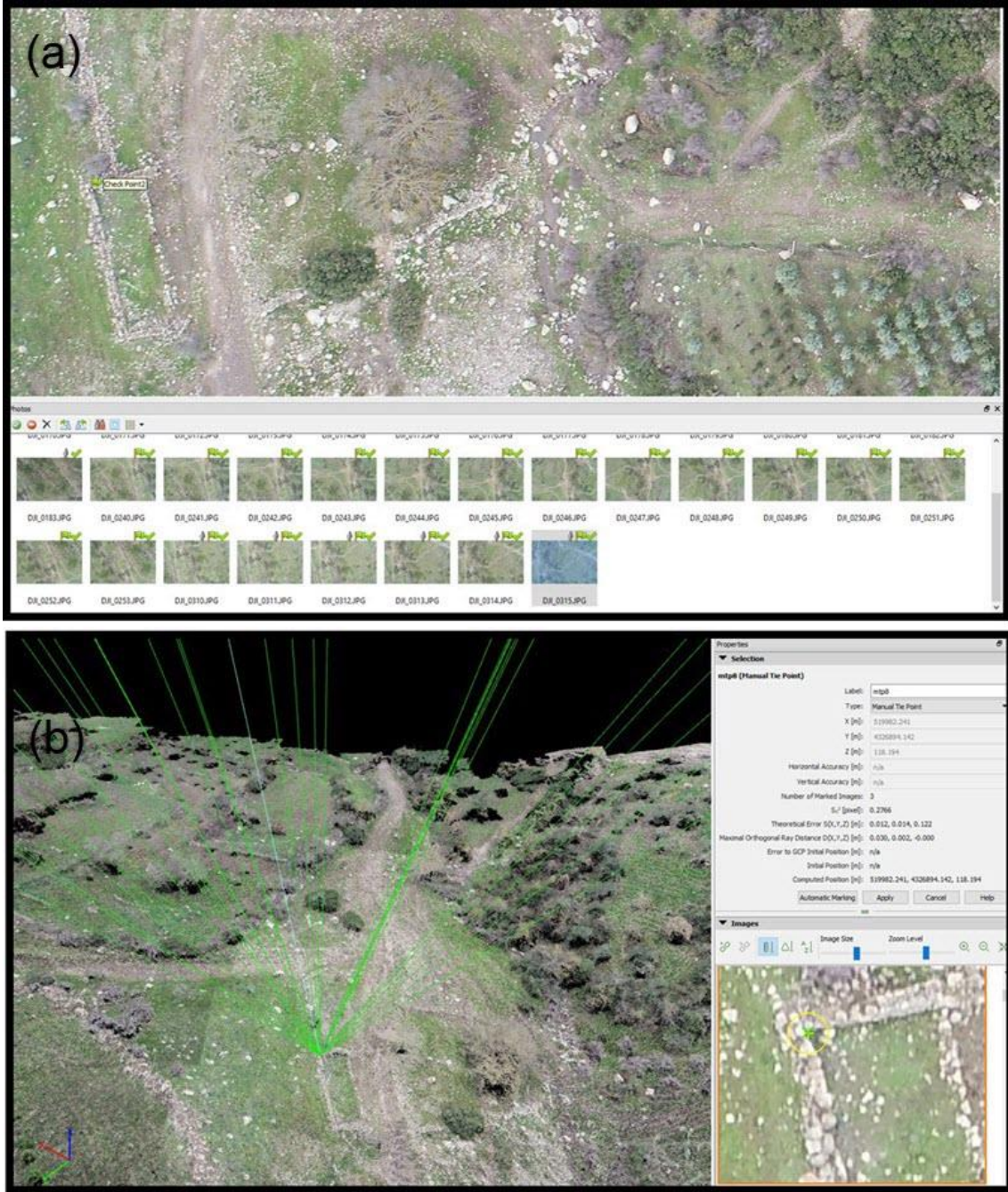
Şekil 4.23 Model koordinatlarının fotogrametrik yazılımlar üzerinden ölçülmesi. (a) Agisoft Photoscan, (b) Pix4D Mapper Pro.
