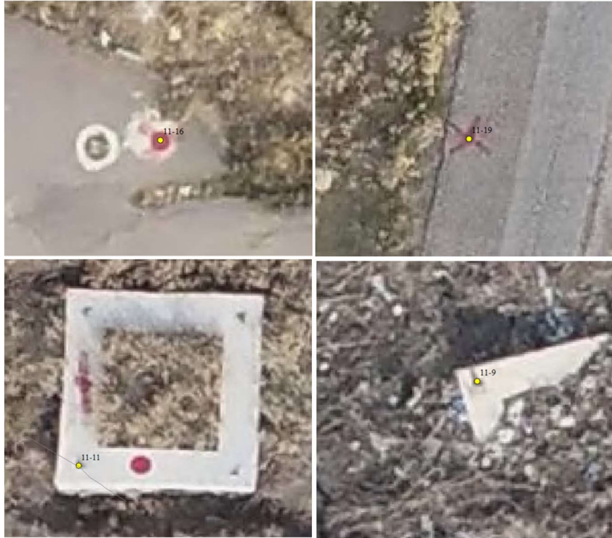
Resim 5.9 Ortofoto üzerinde işaretlenen GNSS ölçüm noktalarına örnek.
