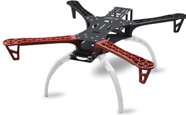
Şekil 4.10 F450 Spider dört pervaneli helikopter gövde ve iniş takımı.
