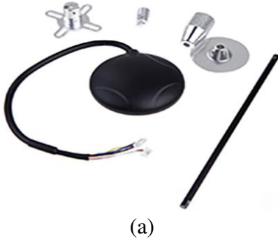
Şekil 4.7 GPS ve sonar modülleri. a) Ublox 6M GPS, b) Sonar (MBI030).
