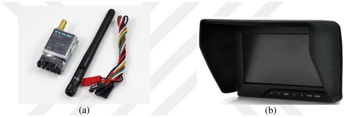
Şekil 4.6 Görüntü modülleri a) 5.8GHz Görüntü aktarım modülü, b) FPV Monitör.
