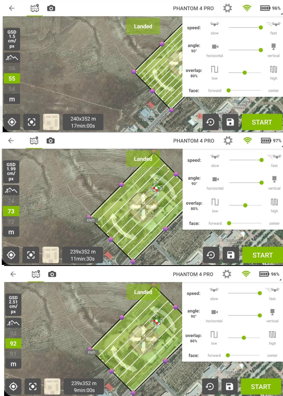
Şekil 4.10. Pix4D Capture uygulaması ile hazırlanan uçuş planları, DJI Phantom Pro4 için farklı yüksekliklerde
