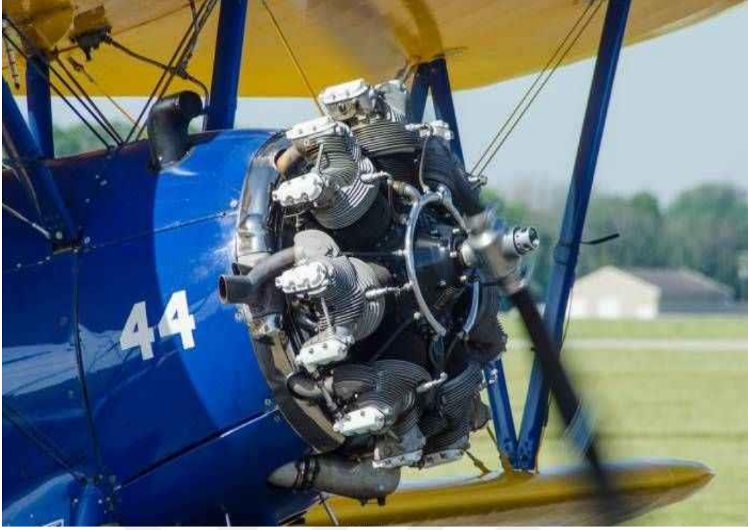
Şekil 1.8. Radyal uçak motoru hava soğutmalı
