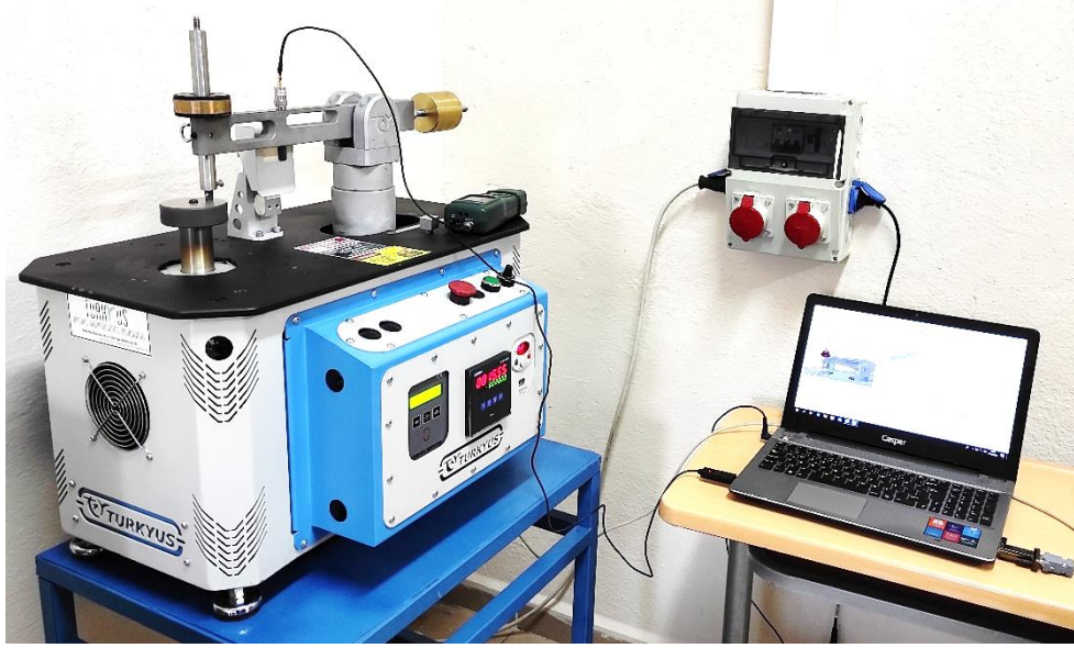
Şekil 5.5. Türkyus marka Pin On disk aşınma test cihazı
