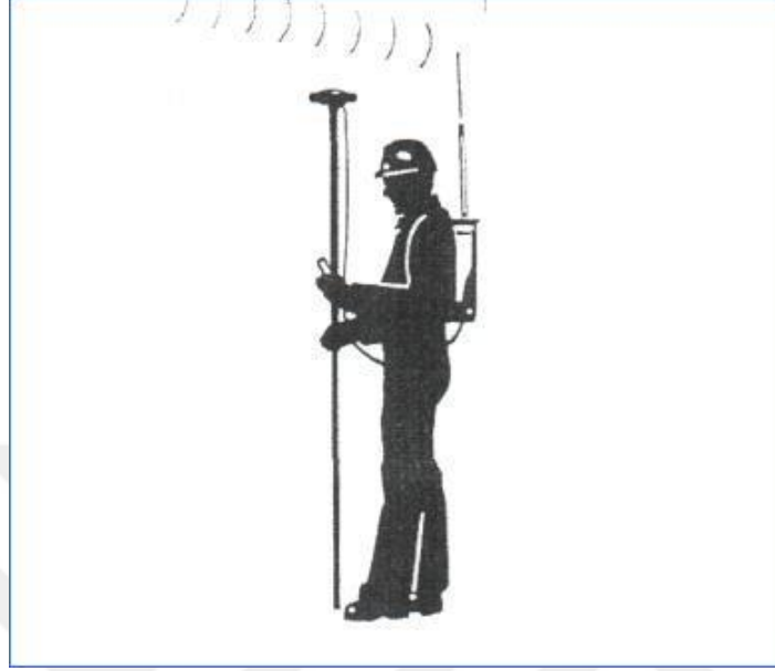
Şekil 4.6 Jeodezik Amaçlı GNSS Alıcısı (İnt.Kyn.7).
