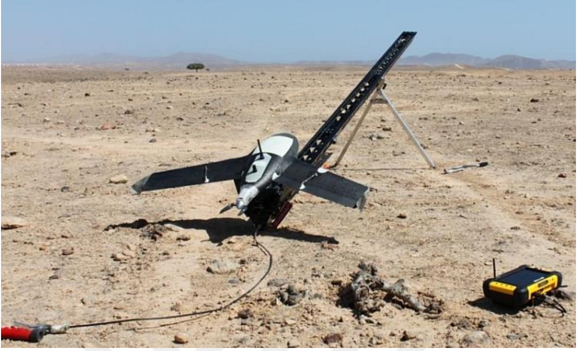
Resim 4.2 Sabit Kanatlı Drone ve Fırlatma Rampası (İnt.Kyn.16).
