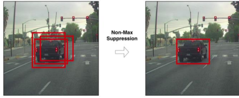
Şekil 2.40 Maksimum olmayanı önleme (non-maximum suppression) [46]
