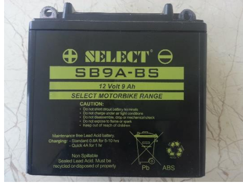
Şekil 3. 23. ATV aracın çalışma sisteminde kullanılan 12V 9Ah kuru akü
