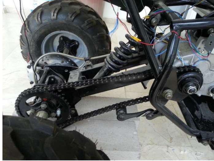
Şekil 3. 15. Gücün tekerleklere aktarımını sağlayan zincir sistemi
