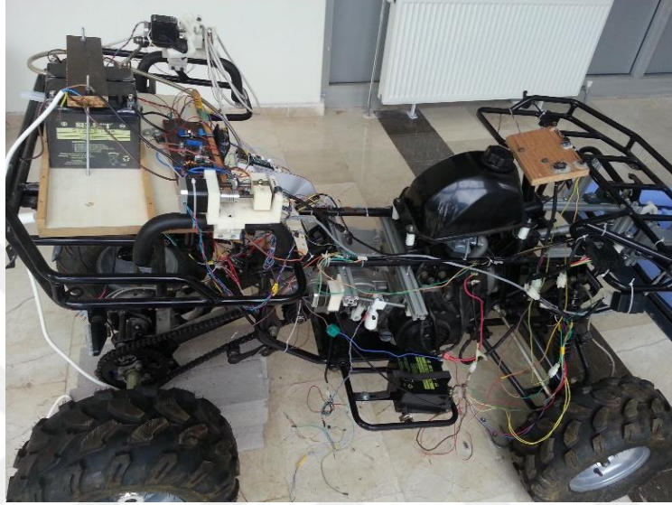
Şekil 3. 2. Modifiye edilerek kontrol edilebilir hale getirilmiş İKA.
