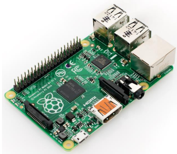
Şekil 3. 29. Raspberry Pi Model B+ İnsansız Kara Aracımızda kullanılan mini bilgisayar
