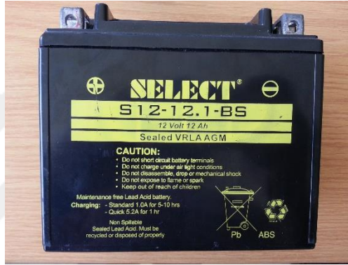
Şekil 3. 24. Kontrol sistemi ve mekanizmaların çalışmasında kullanılan 12V 12Ah kuru akü
