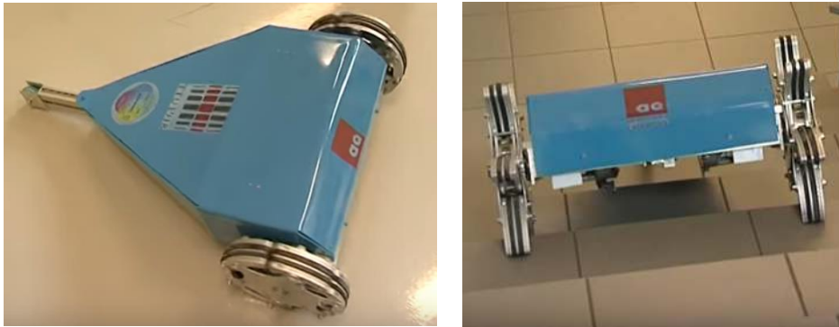
Şekil 1.22. Whег robot bacak modu ve tekerlek modu
