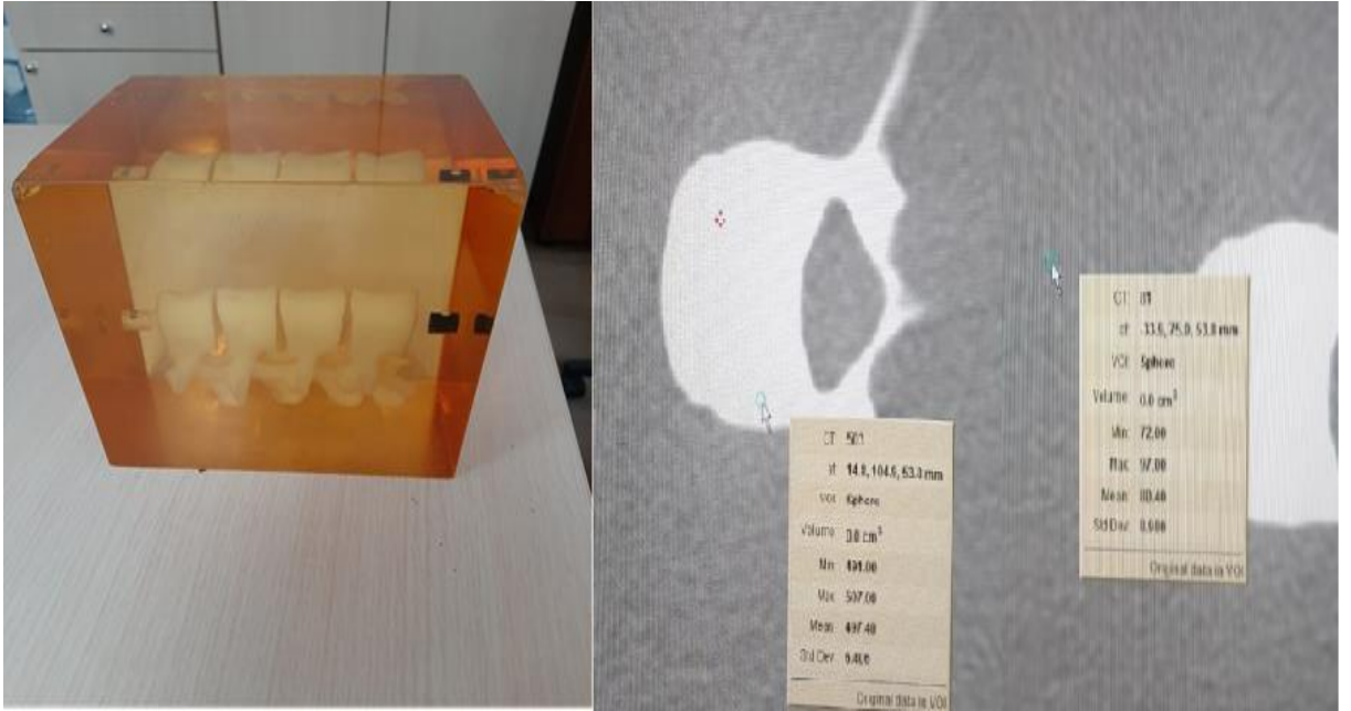
Şekil 3.1: İnsan benzeri vertebra fantomu BT taramasında kemik dokunun 500 HU, yumuşak dokunun ise 81 HU olduğu saptandı.
