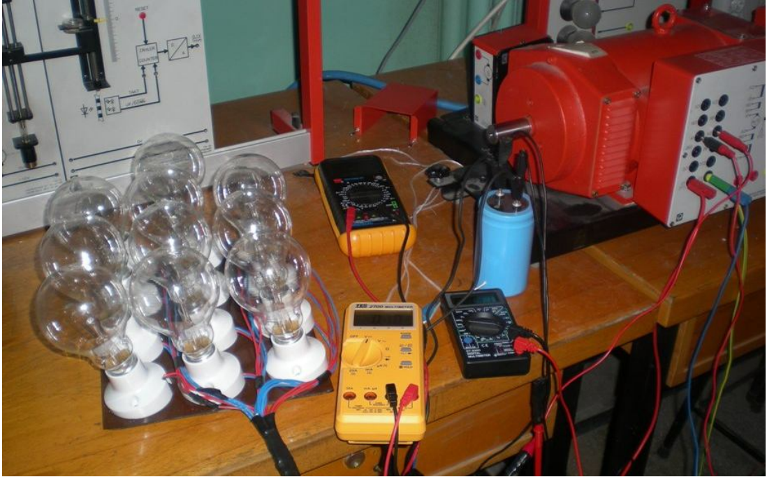
Resim 6.4. Deneylerde yük olarak kullanılan 1 kW'lık seri lamba düzeneği ve ölçü aletleri
