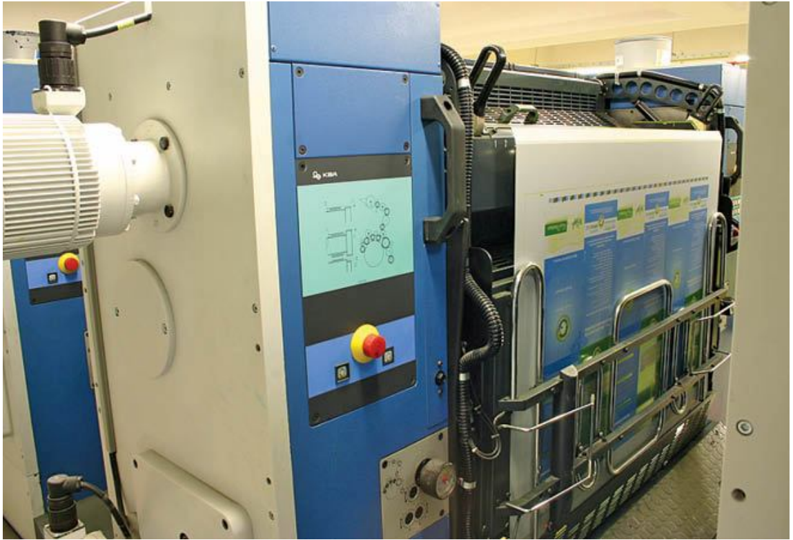
Şekil 10. Ofset baskı için kullanılan kalıbın baskı makinesine yerleştirilirken görüntüsü
