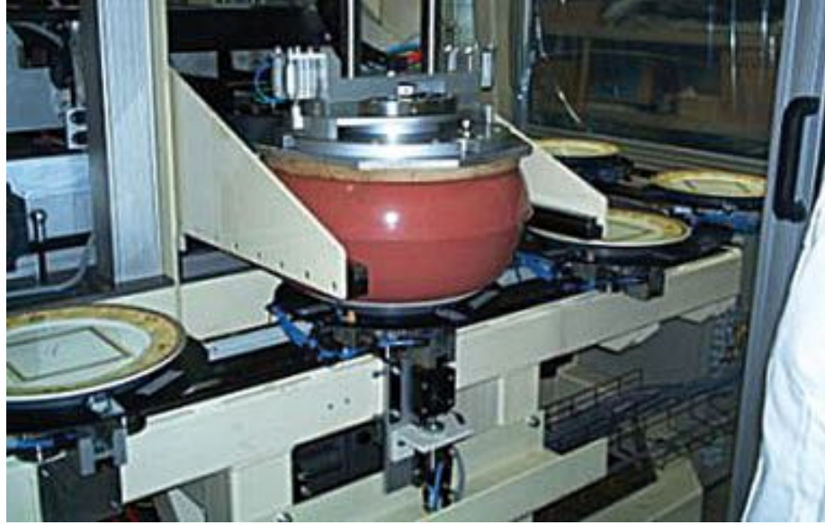
Şekil 13. Baskı sırasında bir tampon baskı makinası
