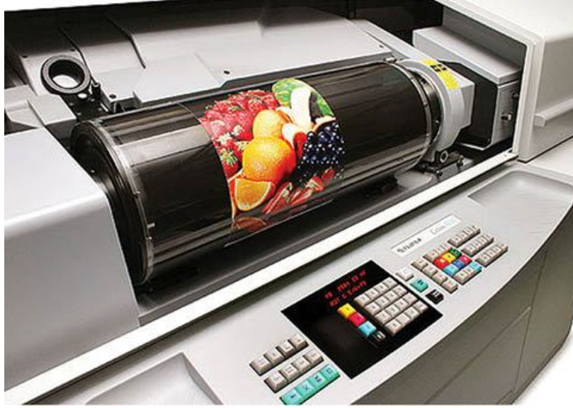
Şekil 8. Tamburlu (Drum) tarayıcı
