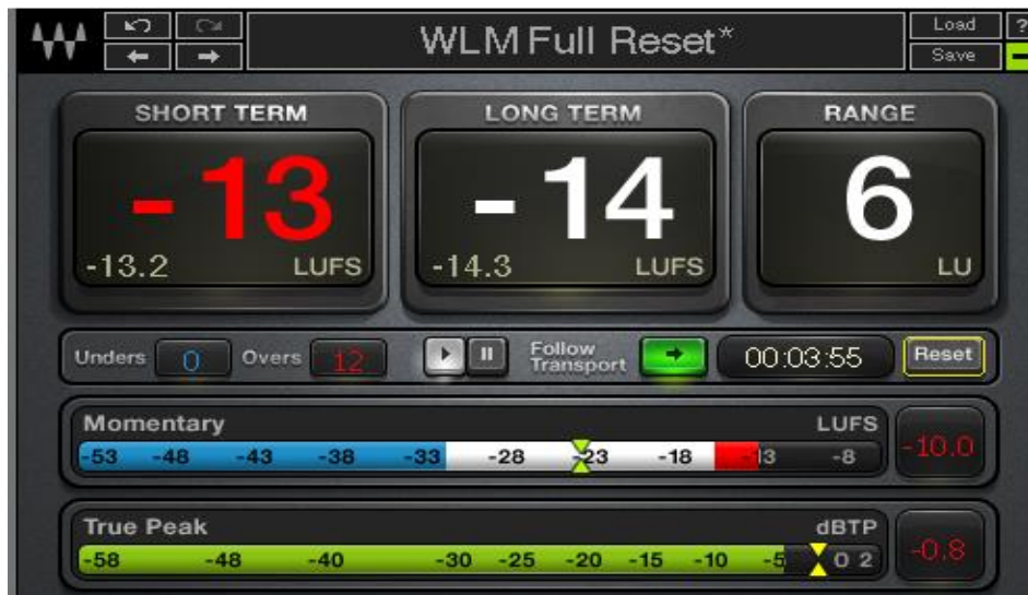
Şekil 24. Spotify loopback kayıt verisinin ses gürlüğü ölçümü.
