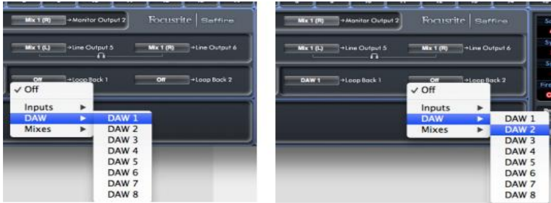
Şekil 20. Saffire Pro Mix yazılımı üzerinden sinyal yönlendirmeleri.
