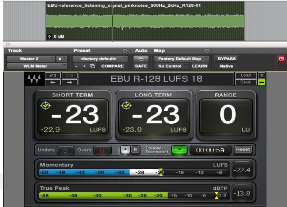
Şekil 26. Ebu Referans Sinyal ile Loopback Sinyal Akışının Doğrulanması.
