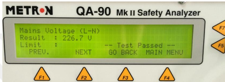
Şekil 38. Cihaz-toprak arası voltaj ölçüm test sonucu (L-N)(Faz-Nötr)
