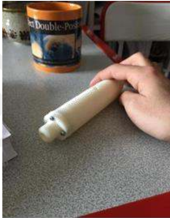
Şekil 16. Prob gövdesi üretiminde ilk çalışmalar, arka kısımın montajı baskı
