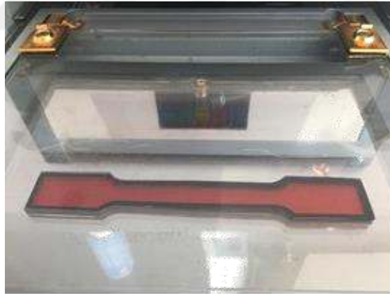
Şekil 47. Standarda uygun kalıpta polimer hazırlama aşaması
