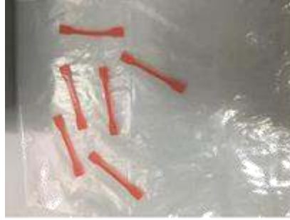
Şekil 49. Mekanik test için hazırlanan yeni numuneler
