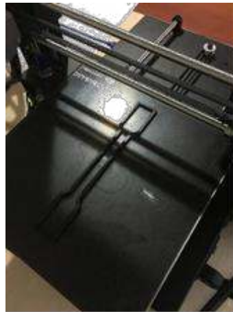
Şekil 45. Üç boyutlu yazıcı ile çekme testi standardı için hazırlanan kalıp
