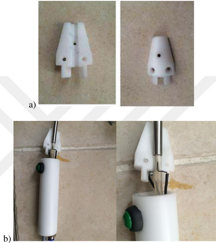
Şekil 18. Plazma Prob üretimi a) Yatak b) Tutucu gövde ve elektrot entegrasyonu
