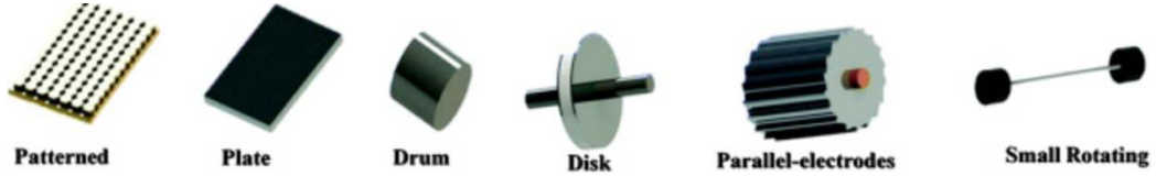
Şekil 2.16. Elektroğirme sisteminde kullanılan farklı toplayıcı (kolektör) örnekleri
