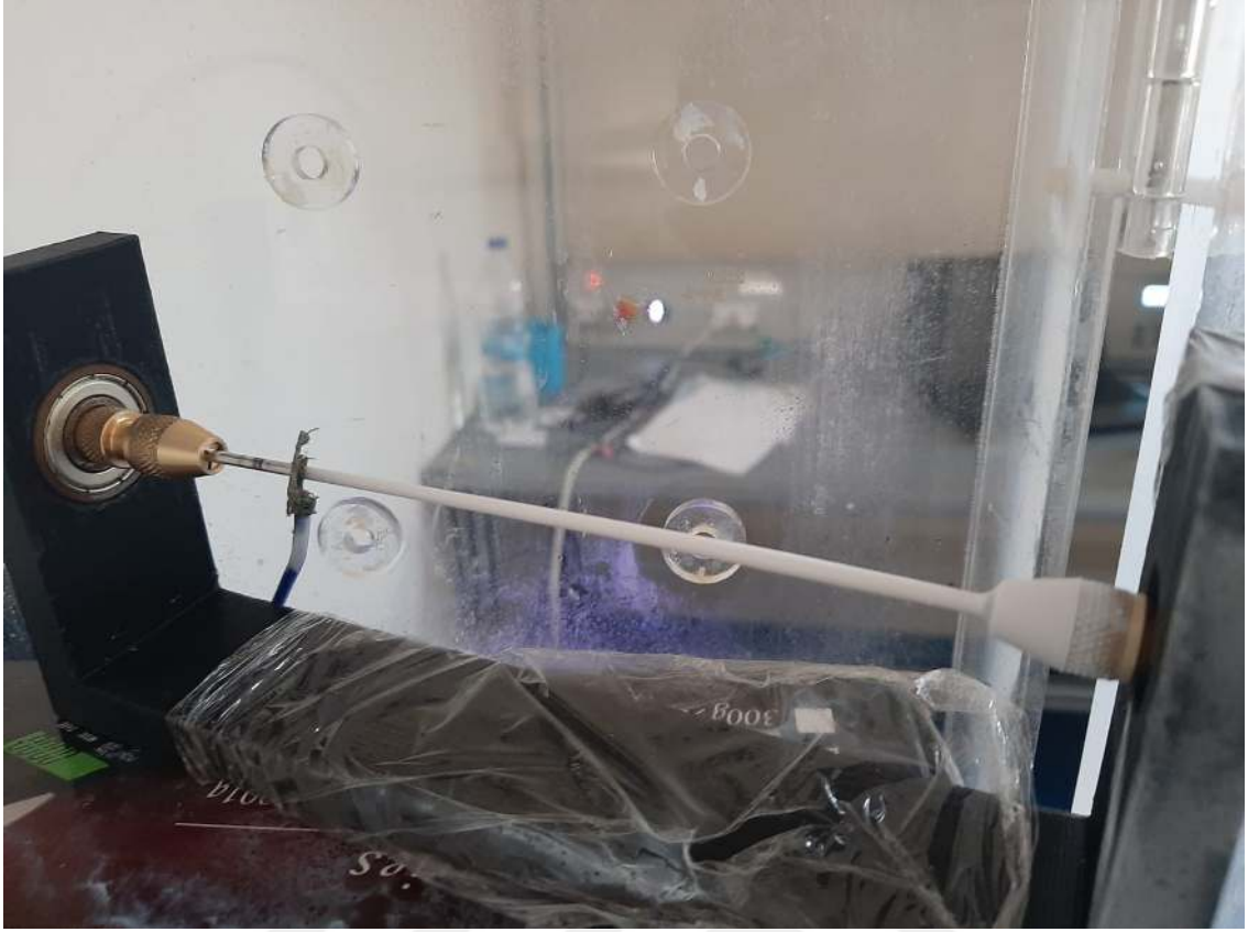
Şekil 3.5. Döner Çubuk toplayıcı üzerine nanofiber sarılması
