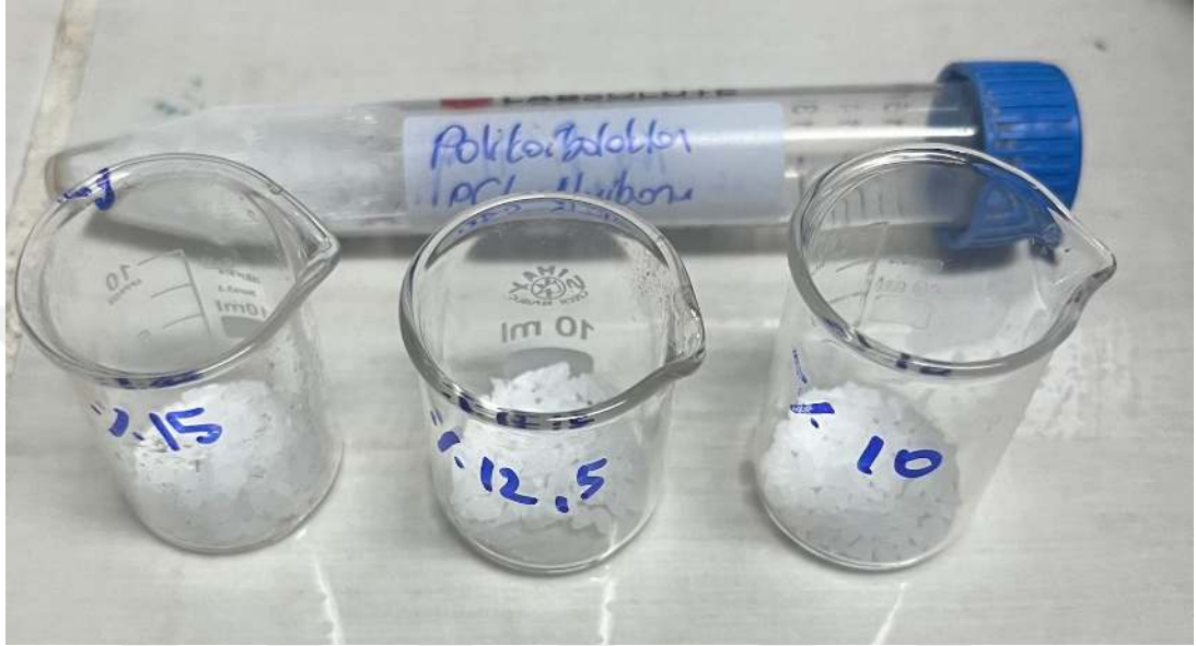
Şekil 3.6. Farklı yüzdelerde PCL çözeltilerinin hazırlanması
