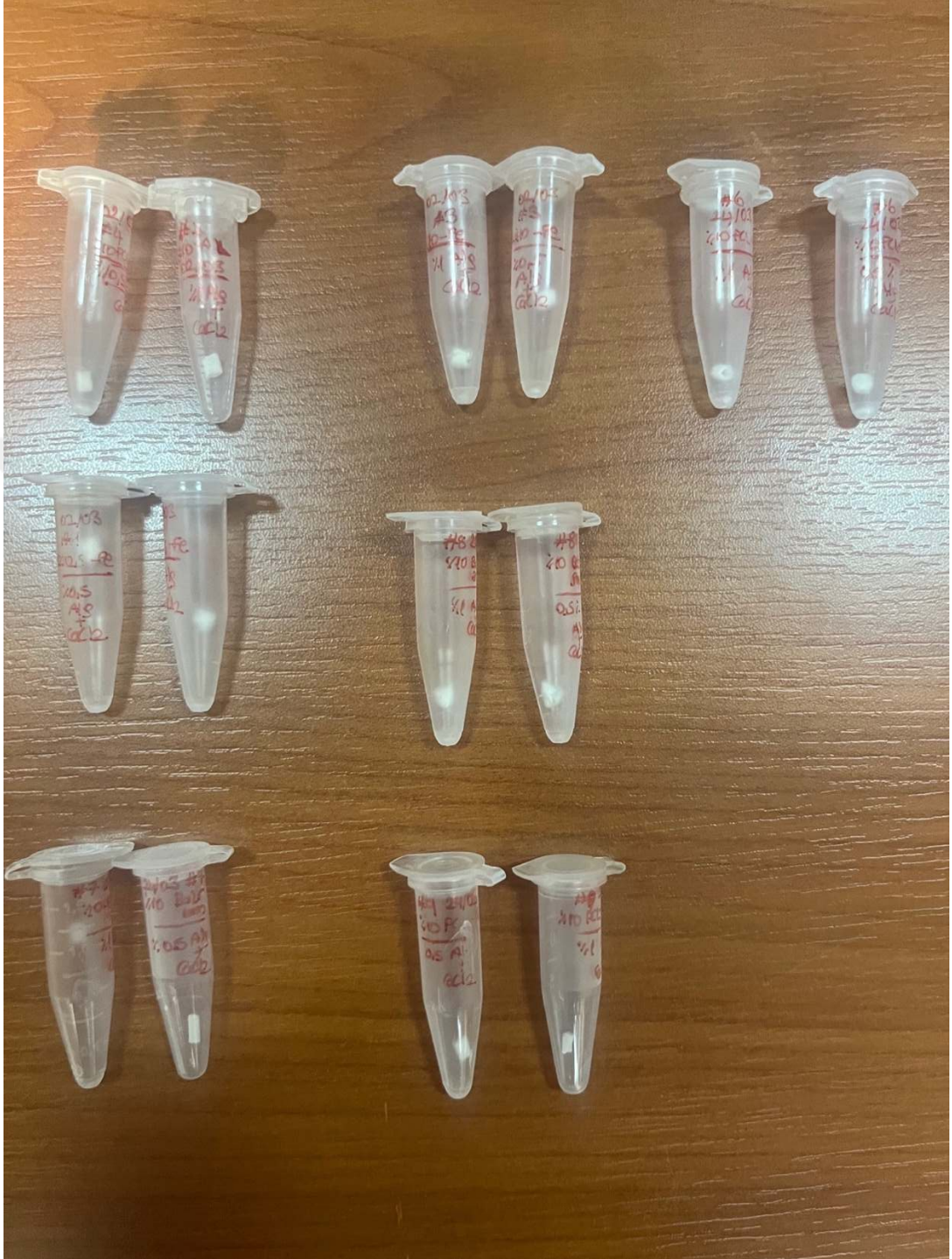
Şekil 3.7. Eppendorf tüplerinde Hidrojel ile kaplanmak için hazırlanan fiberler
