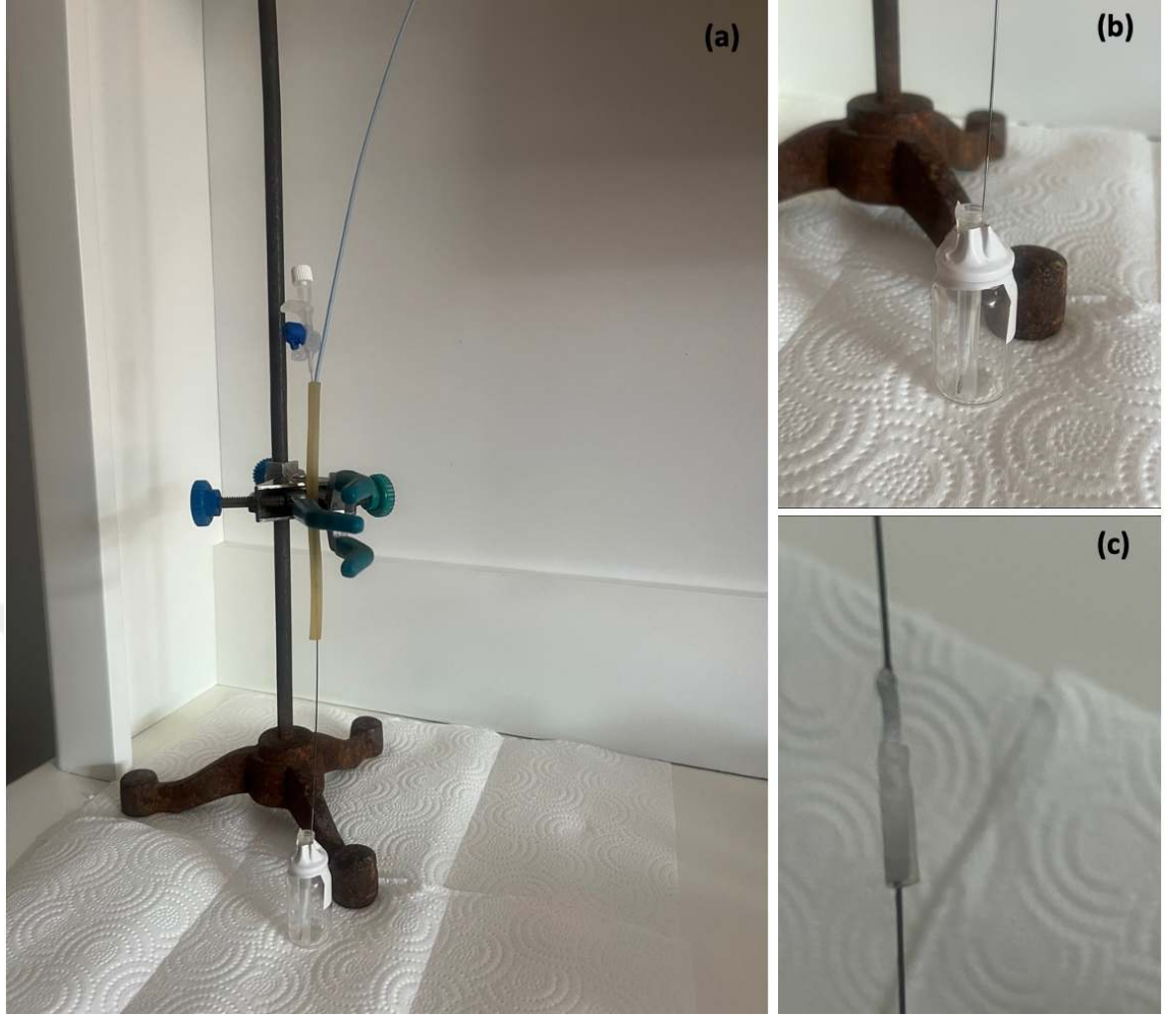
Şekil 3.9. Koil iletim sistemine entegre naofiberin hidrojel ile kaplanma prosedürü (a), Sistemin yakın görüntüsü (b), Hidrojel kaplandıktan sonraki görüntü (c).
