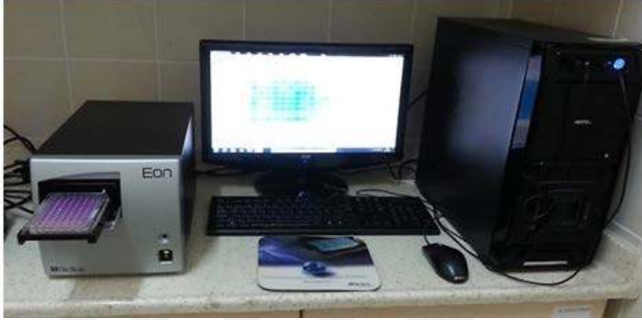
Şekil 18. Doksan Altı Kuyucuklu Hücre Kültür Kabının Plate Okuyucuyla (Eon, Biotek marka) Değerlendirilmesi.
