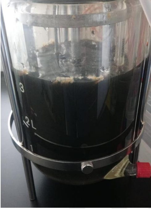
Şekil 4.43. pH kontrolsüz ve havalandırmasız ortamda yetersiz fungal gelişim
