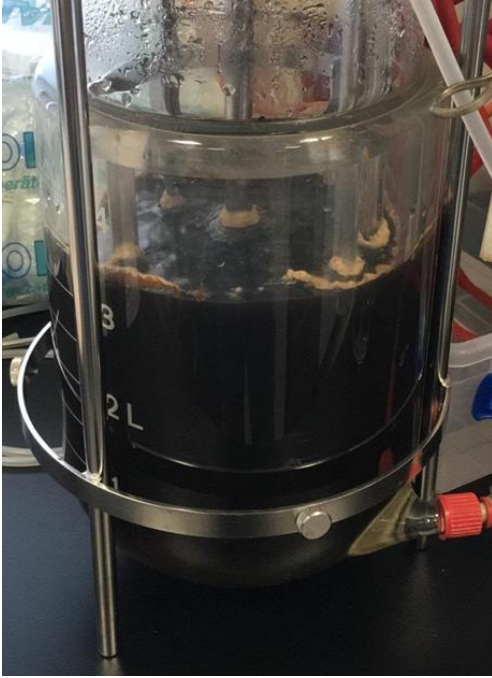
Şekil 4.45. pH kontrollü ve havalandırmasız ortamda yetersiz fungal gelişim
