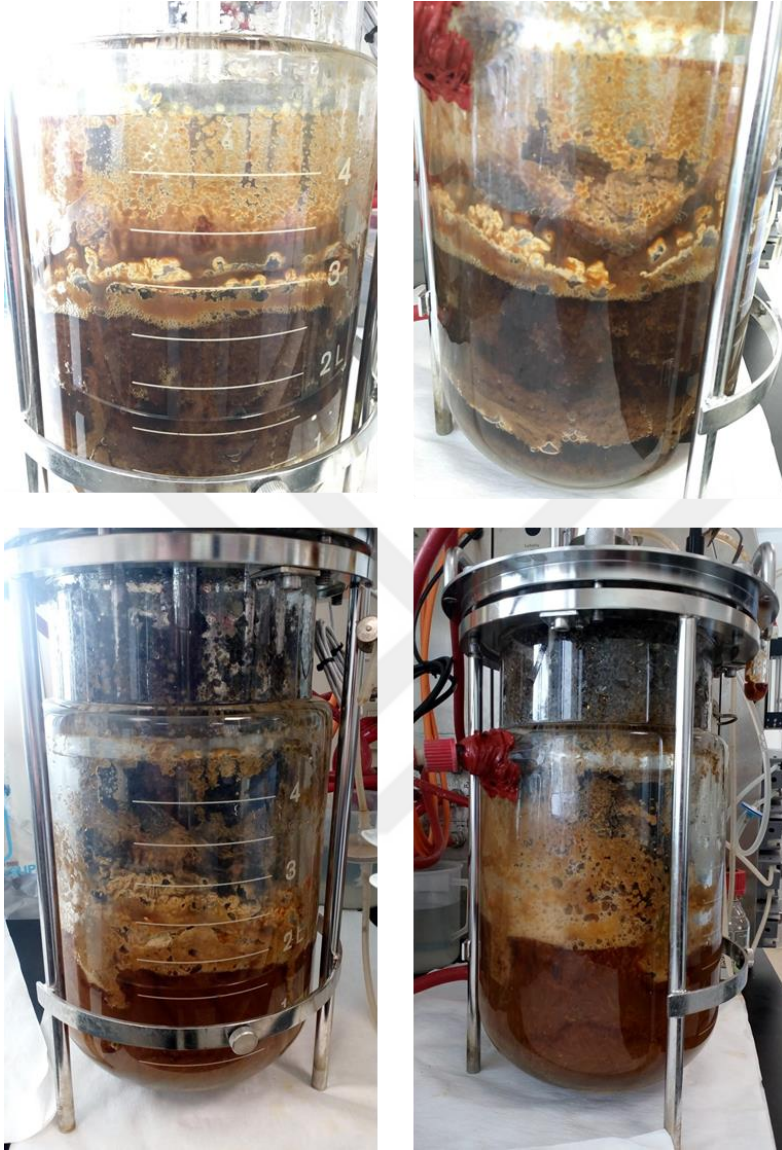
Şekil 4.47. pH kontrolsüz ve havalandırılmalı biyoreaktörde aşırı ve düzensiz fungal gelişim
