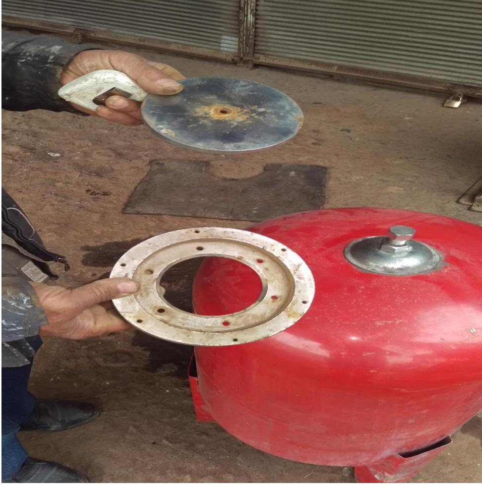
Şekil 4.2. Hidroforun kapak kısmı için kullanılan malzemeler
