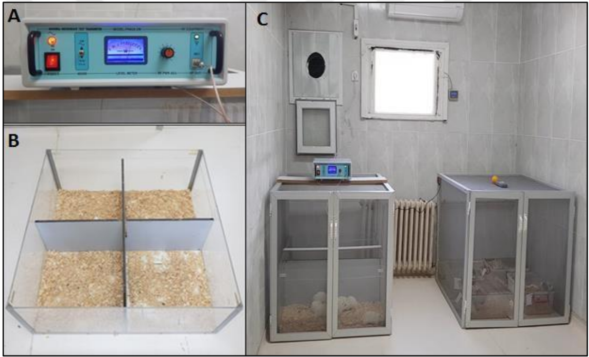
Şekil 3.1. RF-EMA uygulama düzeneği. A) RF jeneratörü, B) Özel uygulama kafesi, C) Kontrol ve RFR grupları için Faraday kafesleri.
